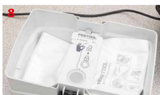
Zamontowany w zbiorniku odkurzacza Festool CTM MIDI I jednorazowy worek tkaninowy
