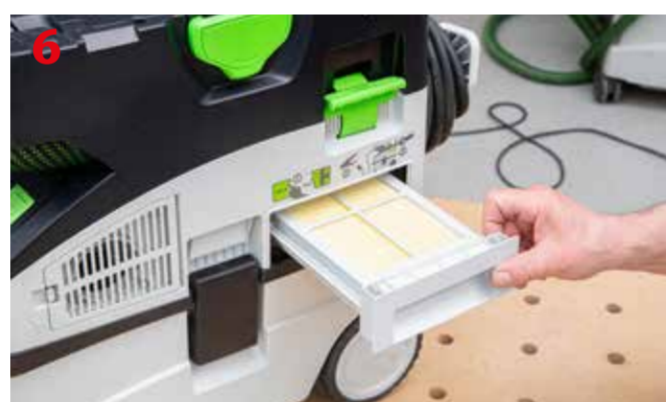
Montaż filtra do pracy na sucho w odkurzaczu Festool CTM MIDI I
