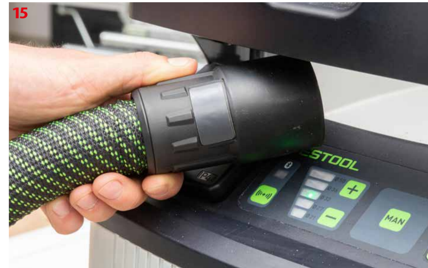
Znacznik RFID umieszczony na mufie węża i na panelu sterowania zapalony ledowy wskaźnik średnicy węża
