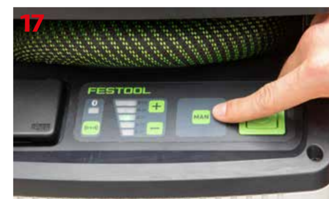
Oddzielny włącznik do uruchamiania odkurzaczy Festool CTL MINI oraz CTL MIDI i CTM MIDI w przypadku wykorzystania ich np. do sprzątnięcia
