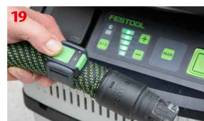
Pilot bluetooth służący do zdalnego uruchamiania odkurzacza
