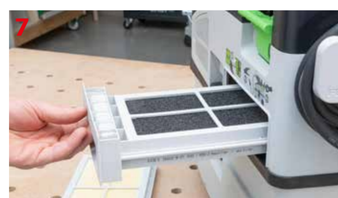
Montaż filtra do pracy na mokro w odkurzaczu Festool CTM MIDI I
