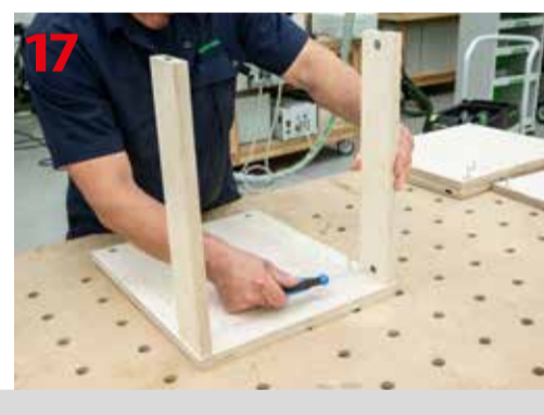
Montaż cokołów do boków szafki
