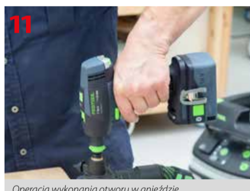
Operacja wykonania otworu w gnieździe
