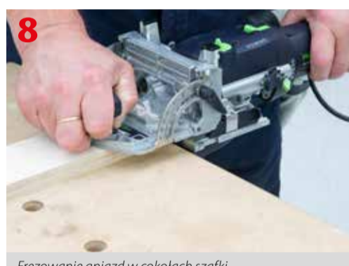
Frezowanie gniazd w cokołach szafki
