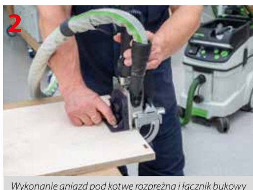
Wykonanie gniazda pod kotwę rozprężną i łącznik bukowy
