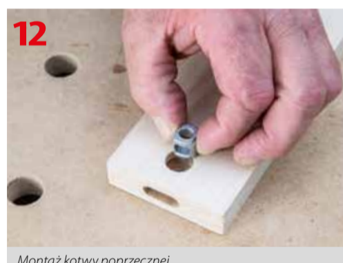
Montaż kotwy poprzecznej
