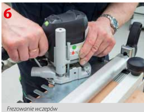
Elementy systemu VS 600 używane do wykonania otwartych połączeń na jaskółczy ogon dla elementów o przekrojach 10-14 mm
