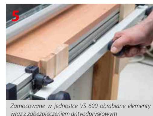
Montaż szablonu do wcięć
