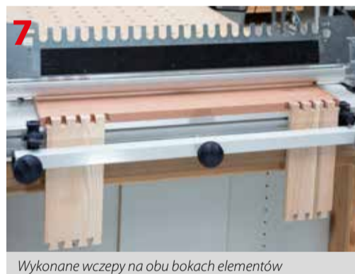
Elementy systemu VS 600 używane do wykonania otwartych połączeń na jaskółczy ogon dla elementów o przekrojach 10-14 mm
