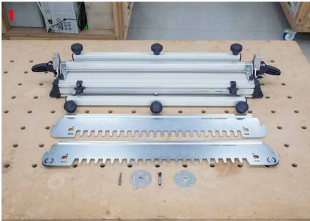
Elementy systemu VS 600 używane do wykonania otwartych połączeń na jaskółczy ogon dla elementów o przekrojach 10-14 mm
