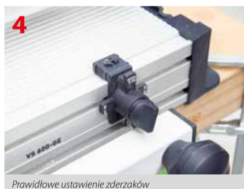
Prawidłowe ustawienie zderzaków
