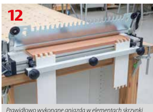
Prawidłowo wykonane gniazda w elementach skrzynki
