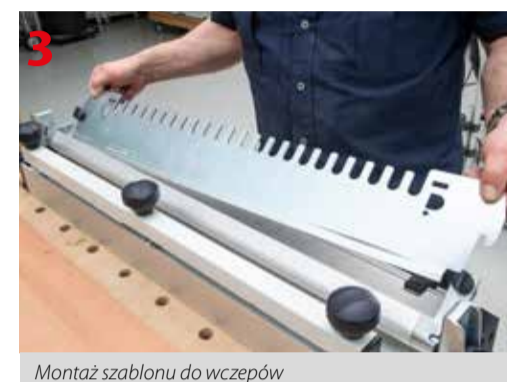
Elementy systemu VS 600 do otwartych połączeń na jaskółczy ogon dla elementów o przekrojach 14-25 mm
