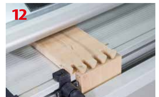
Wyfrezowany narożnik skrzynki po obróceniu elementu
