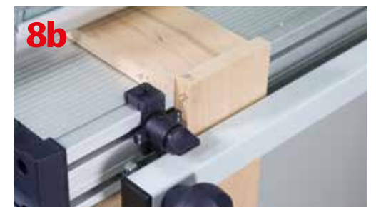
Wyfrezowany narożnik skrzynki po obróceniu elementu
