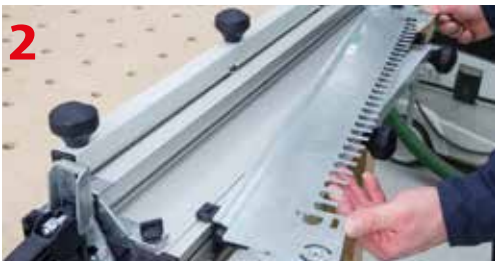
Zakładanie szablonu SZ14 w jednostce podstawowej VS 600
