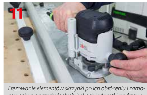
Prawidłowe zamontowanie elementów w jednostce podstawowej VS 600
