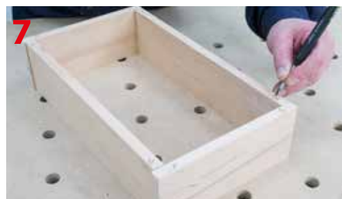
Oznaczanie narożników frezowanych elementów
