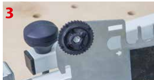
Mimośrodek służący do regulacji głębokości gniazd połączeń na jaskółczy ogon
