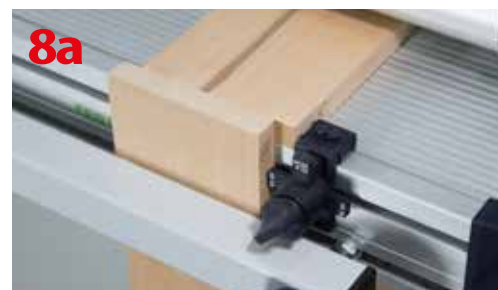
Prawidłowe zamontowanie elementów w jednostce podstawowej VS 600
