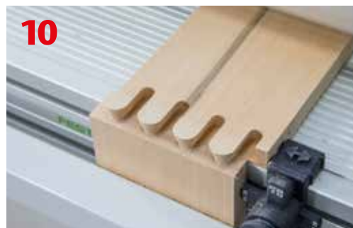
Wyfrezowany narożnik skrzynki
