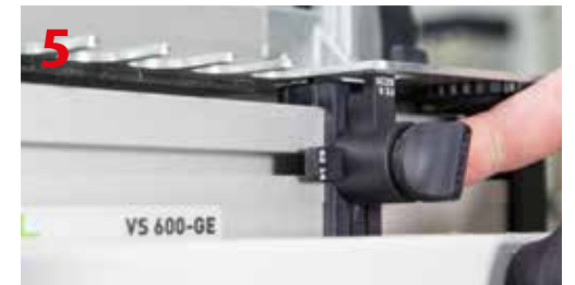
Prawidłowe ustawienie zderzaków SZ14
