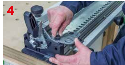
Prawidłowy montaż szablonu SZ14 w jednostce podstawowej VS 600
