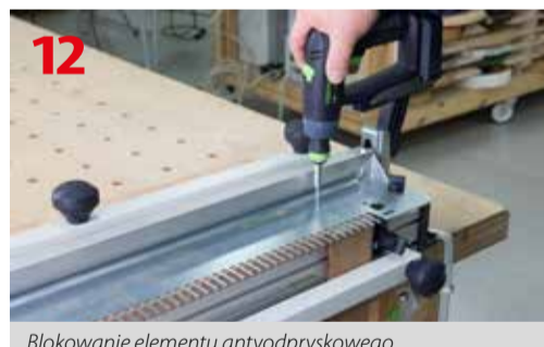
Blokowanie elementu antyodpryskowego z użyciem wkrętów
