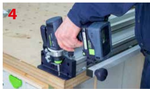
Montaż korpusu systemu Festool VS 600 za pomocą wkrętów
