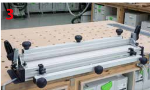
Prawidłowo zamocowana jednostka podstawowa systemu VS 600
