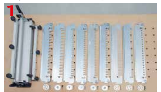
System Festool VS 600: jednostka podstawowa i 9 wymiennych szablonów oraz pierścieni kopiujących
