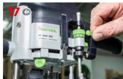
Regulacja głębokości frezowania
