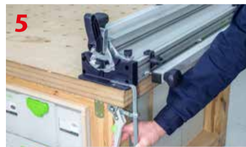
Montaż korpusu systemu Festool VS 600 za pomocą ścisków
