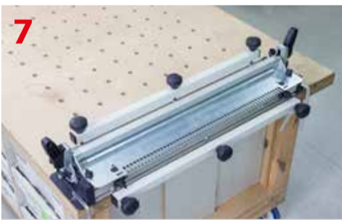
Prawidłowo zamocowany szablon FZ6
