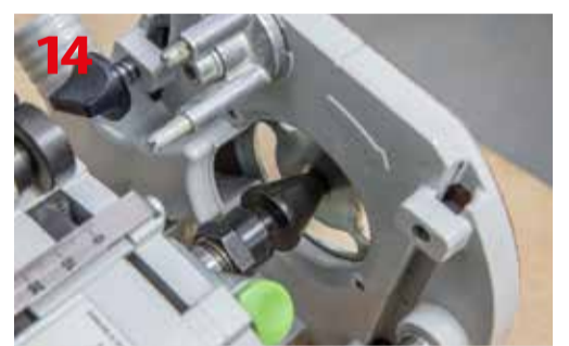
Centrowanie pierścienia z użyciem stożka
