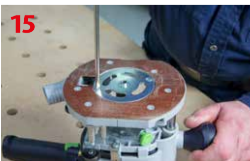
Dokręcanie śrub mocujących pierścieni kopiujących
