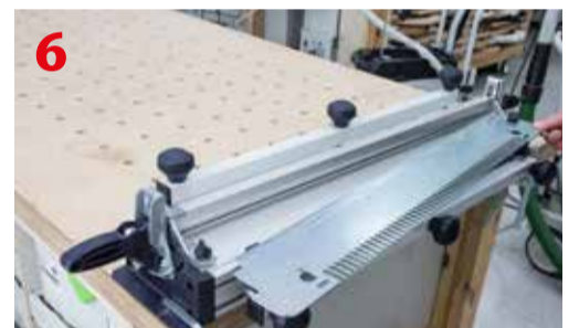
Mocowanie szablonu do połączeń palcowych FZ6
