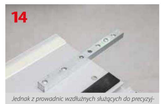
Jednak z prowadnic wzdluznych służących do precyzyjnego ustawiania szyny wzdluz elementu płytowego
