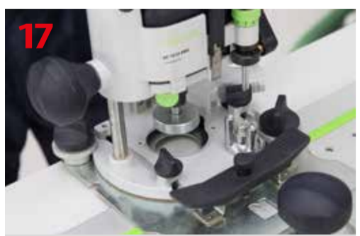
Centrowanie frezarki za pomocą trzpienia
