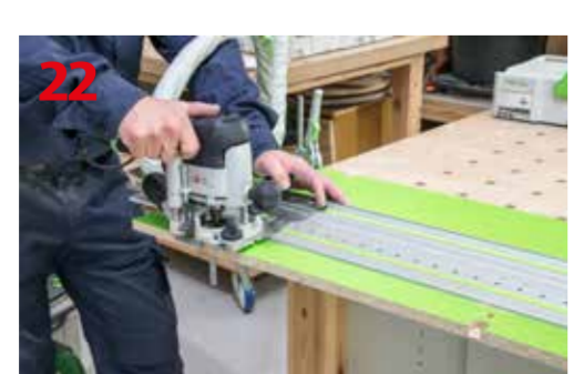
Wykonanie otworów w tylnej ścianie szafki i narzędzia Festool służące do ich wykonania
