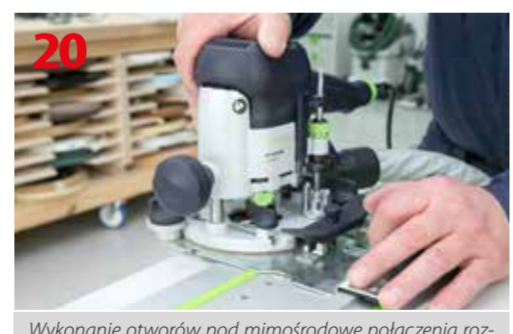
Wykonanie otworów pod mimośrodowe połączenia rozłączne
