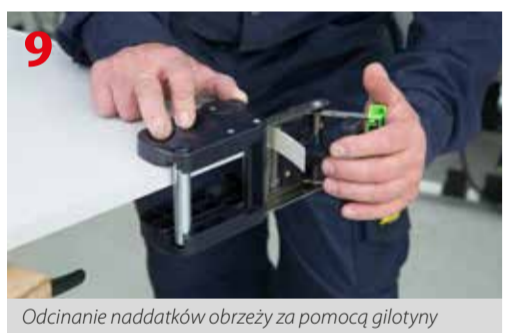
Odcinanie nadwyżek obrzeży za pomocą gilotyny Festool KP 65/2
