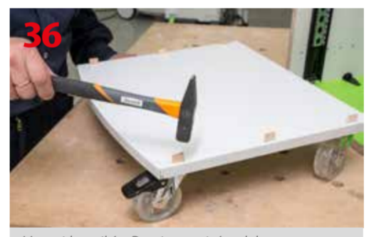
Montaż łączników Domino w wieńcu dolnym
