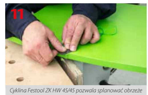
Cyklina Festool ZK HW 45/45 pozwala spławić obrzeża dokładnie z powierzchnią wieńca
