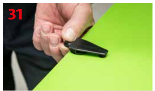
Montaż elementów mimośrodowych połączeń rozłącznych
