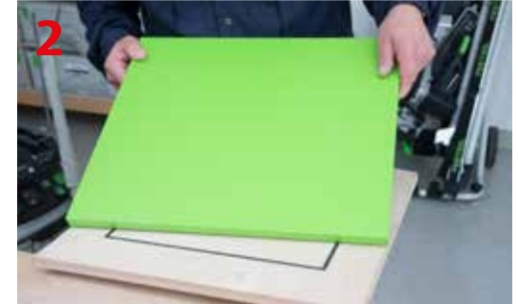
Montowanie szablonu i obrabianego wieńca w mocowaniu próżniowym Festool VAC
