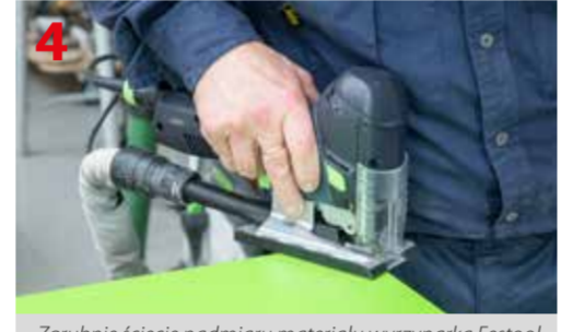
Zgrubnie ścieżenie nadmiaru materiału wyrzynarką Festool PS 420
