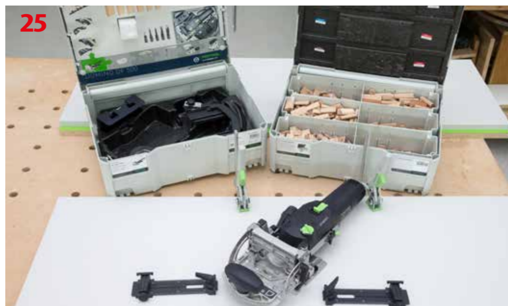
Frezarka Festool Domino DF 500 i przykladnice poprzeczne Festool QA - DF 500 z trzpieniami ustalającymi precyzyjne położenie maszyny
