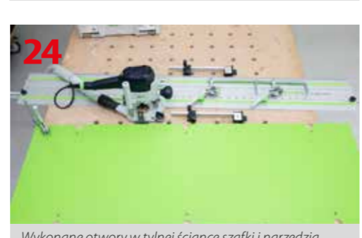
Wykonane otwory w tylnej ścianie szafki i narzędzia Festool służące do ich wykonania
