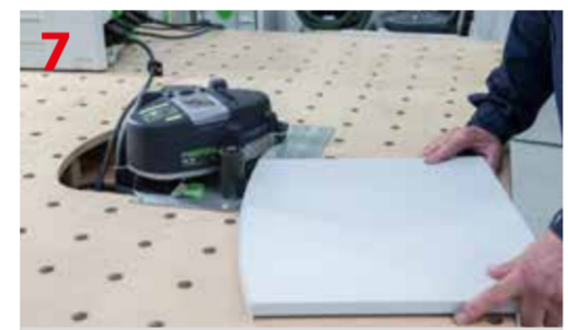
Okleinowanie jednego z wieńców okleinarką Festool Conturo KA 65
