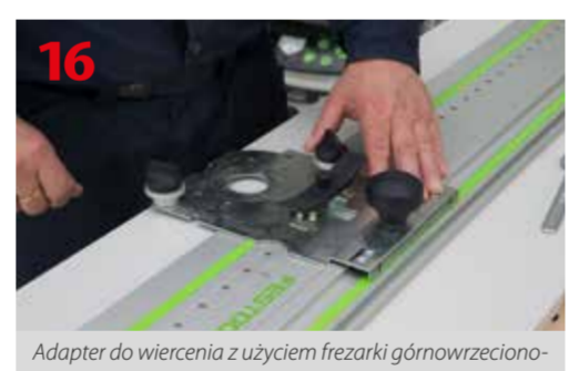
Adapter do wiercenia z użyciem frezarki górnowrzecionowej
