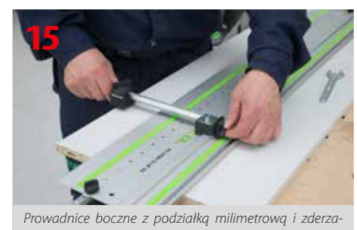
Prowadnice boczne z podziałką milimetrową i zderzakiem przesuwalnym
