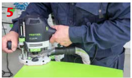
Frezowanie wieńca frezarką górnowrzecionową Festool OF 1400
