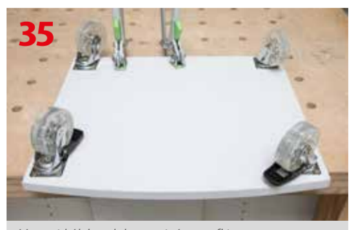
Montaż kółek w dolnym wieńcu szafki
