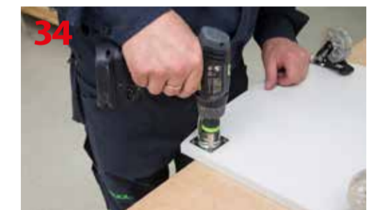
Montaż kółek w dolnym wieńcu szafki
