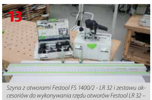
Szyna z otworami Festool FS 1400/2 - LR 32 i zestawu akcesoriów do wykonywania rzędu otworów Festool LR 32 - SYS oraz frezarka górnowrzecionowa Festool OF 1010 EBO
