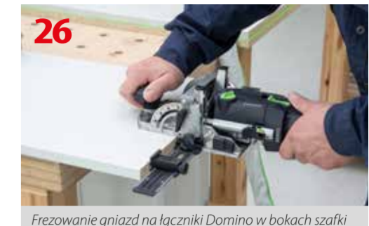
Frezowanie gniazd na łączniku Domino w bokach szafki
