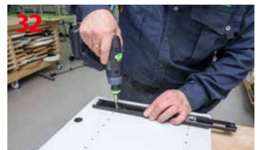
Montaż prowadnic szuflad Festool SYS-AZ
