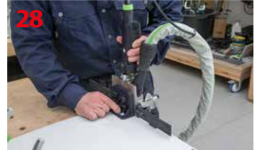
Frezowanie gniazd na łączniku Domino w wieńcach szafki
