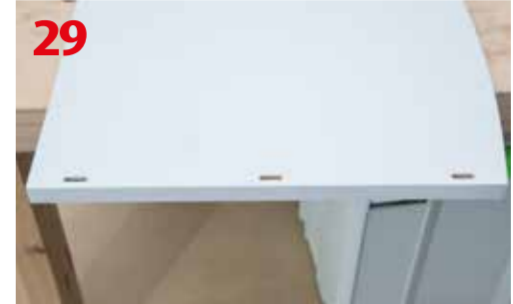
Wykonane gniazda w wieńcu szafki
