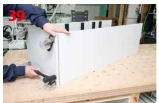
Połączenie boków i tyłu szafki z wieńcem dolnym
