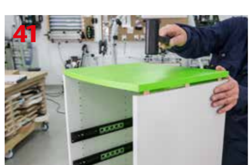
Montaż wieńca górnego
