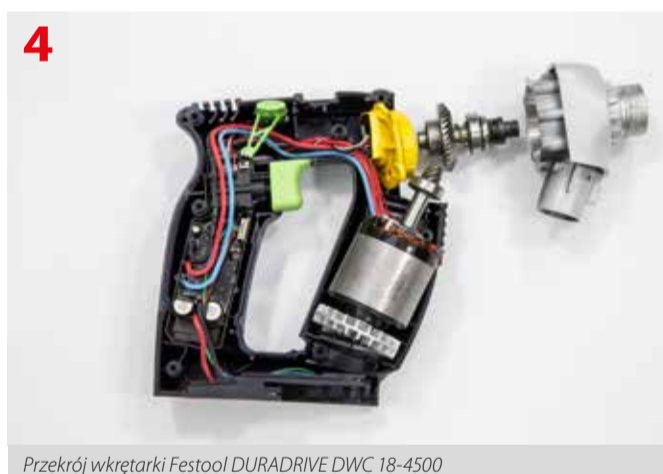
Przekrój wkrętarce Festool DURADRIVE DWC 18-4500
