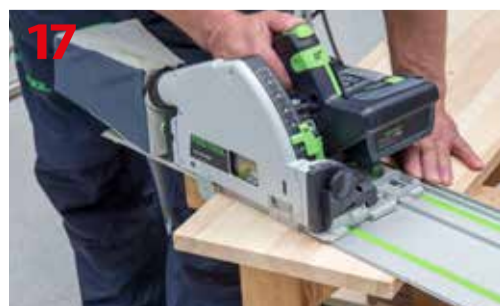
Cięcie skośne zagłębiarką Festool TSC 55 REB
