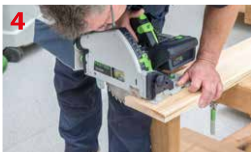
Cięcie deski litej zagłębiarką Festool TSC 55 REB wymagające wychylenia się operatora
