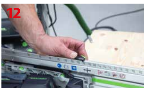
Łatwe i szybkie ustawianie kątów cięcia na szynie FSK w przypadku pilarki Festool HKC 55 EB
