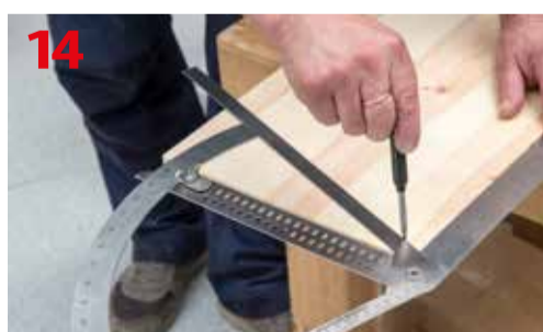
Trasowanie skośnej linii cięcia
