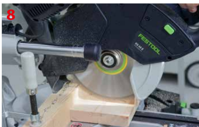
Pilarką możemy naciąć na głębokość 0-60 mm
