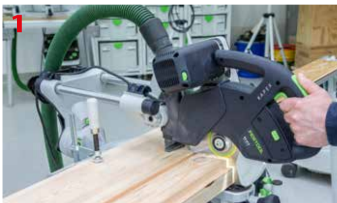
Ukośnica Festool KAPEX KS 60 ma maksymalny zakres cięcia wynoszący 305 x 60 mm
