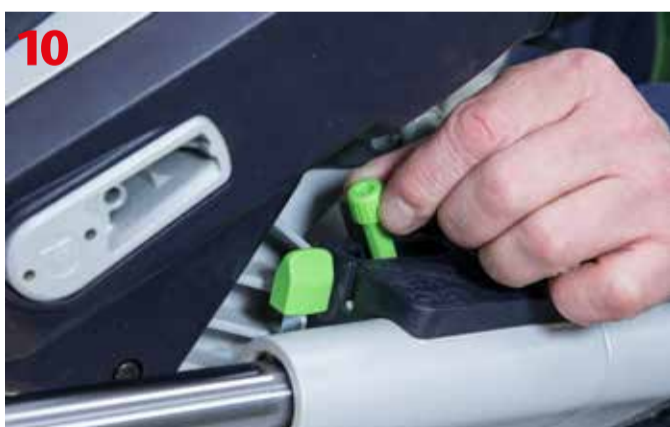
Regulacja głębokości nacinania
