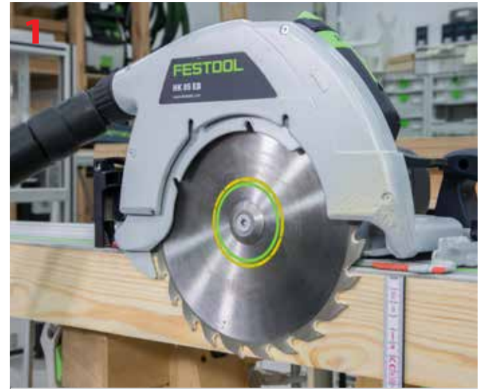
Pilarka Festool HK 85 oferuje nam głębokość cięcia na szynie wynoszącą 80 mm (grubość elementu obrabianego – 78 mm)
