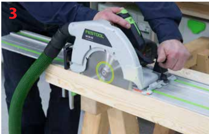
Środkowa faza cięcia, podczas której nie naciskamy dźwigni osłony
