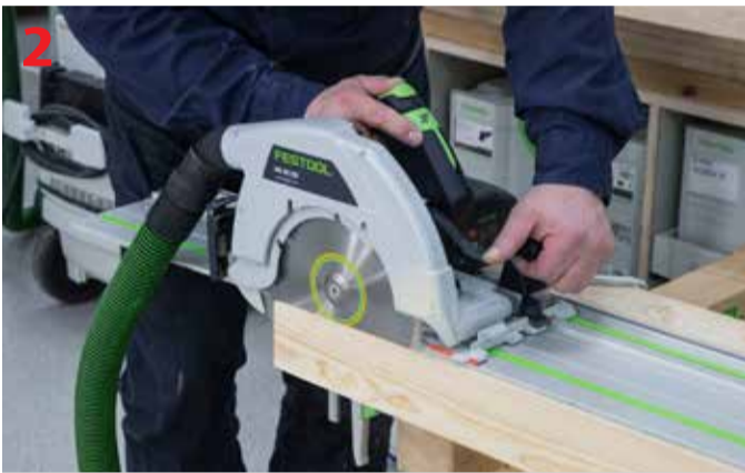
Podczas rozpoczynania cięcia podnosimy za pomocą dźwigni ruchomą osłonę dolną z klinem
