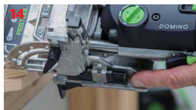
Ustawienie schodkowego zderzaka frezarki do grubości elementu
