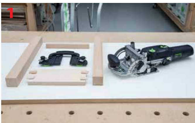
Frezarka Festool Domino DF 500 Q, łączniki Domino 5 x 19 x 30 mm i prowadnica do frezowania wąskich elementów
