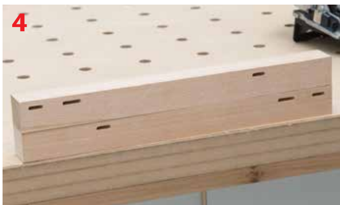
Wykonane gniazda pod łączyny górną i dolną
