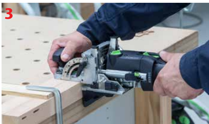
Frezowanie dwóch gniazd na łączynę górną
