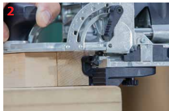
Prawidłowo ustawiony dodatkowy zderzak frezarki Festool Domino DF 500 Q
