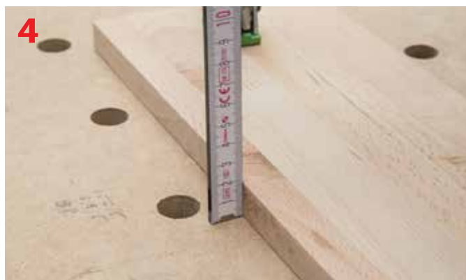
Grubość frezowanego elementu wynosi 18 mm
