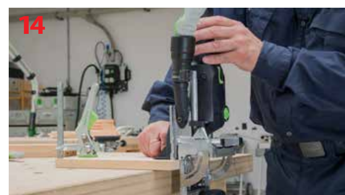
Frezowanie gniazd pionowych w krótszych bokach skrzynki
