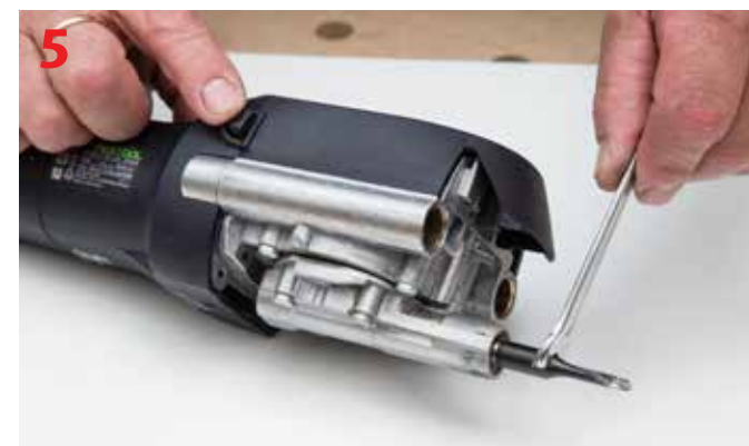
Montaż frezu o średnicy 5 mm
