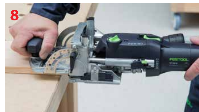
Frezowanie poziomych gniazd w dłuższych bokach skrzynki
