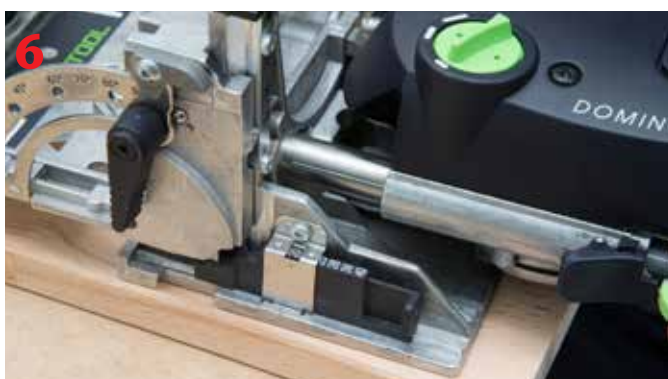
Prawidłowo ustawiony suwak szybkiego wyboru wysokości stolika
