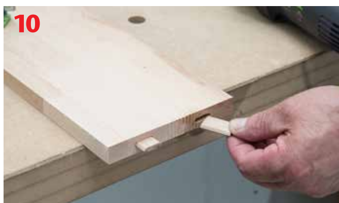
Montaż łączników Domino w bokach skrzynki
