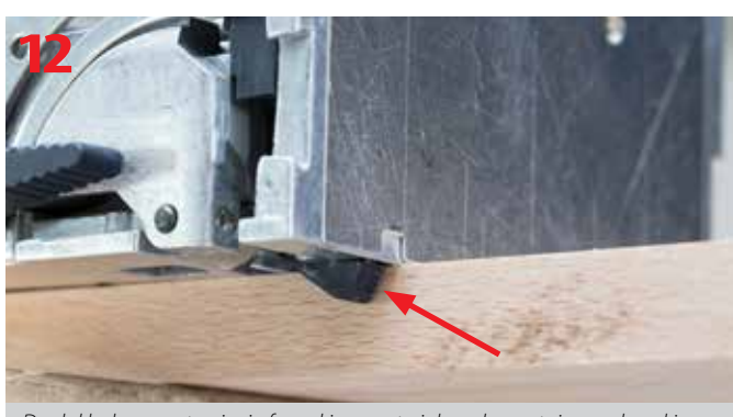
Do dokładnego ustawienia frezarki na materiale wykorzystujemy zderzaki pozycjonujące
