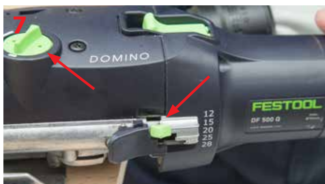
Prawidłowo ustawiona głębokość frezowania i szerokość gniazda
