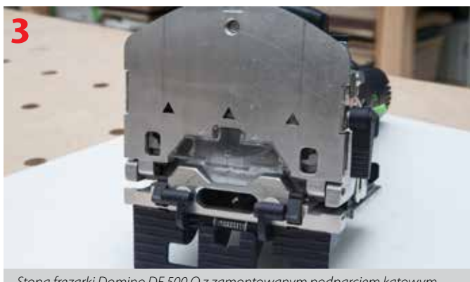
Stopa frezarki Domino DF 500 Q z zamontowanym podparciem kątowym i dodatkowymi zderzakami
