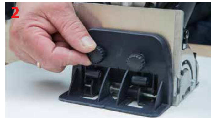
Montaż podparcia kąтового we frezarce Domino DF 500 Q
