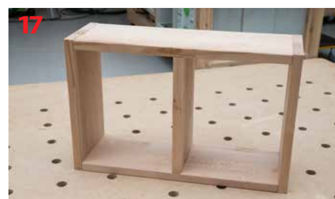
Wykonana skrzynka z przegrodą środkową
