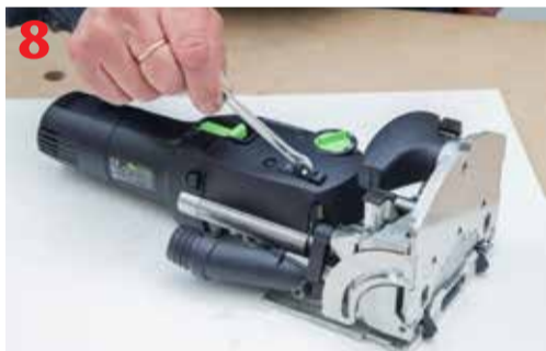
Rozłączenie stolika i korpusu frezarki Festool Domino DF 500 Q
