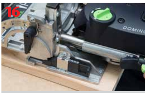
Suwak szybkiego wyboru służący do ustawiania wysokości stolika
