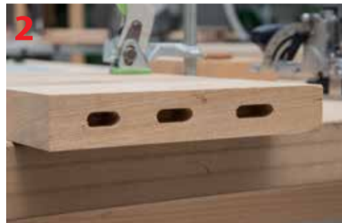
Otwory i łączniki stosowane w systemie Festool Domino DF 500
