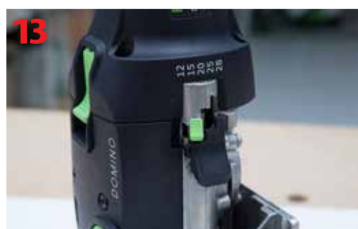
Regulacja głębokości frezowania
