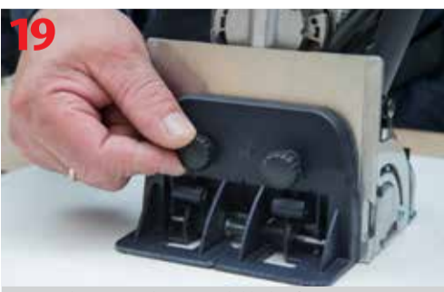
Prowadnica umożliwiająca dokładne frezowanie w pionie
