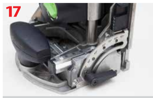
Skala i znacznik służące do ustawiania wysokości stolika w przypadku elementu o niestandardowej grubości.
