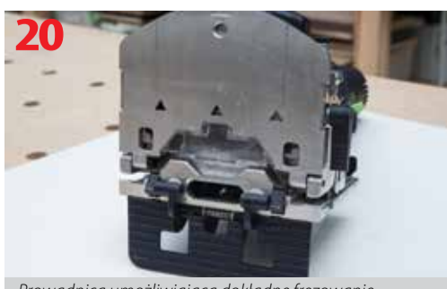
Prowadnica umożliwiająca dokładne frezowanie w pionie
