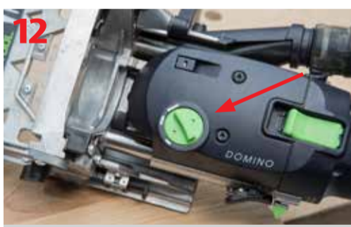
Pokrętło do ustawiania szerokości wykonywanych gniazd pod łączniki Domino
