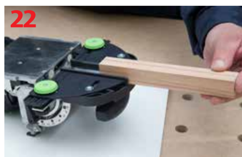
Prowadnica do frezowania wąskich elementów
