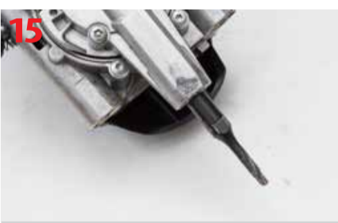
Frez o średnicy 5 mm zamontowany we frezarce Festool Domino DF 500 Q
