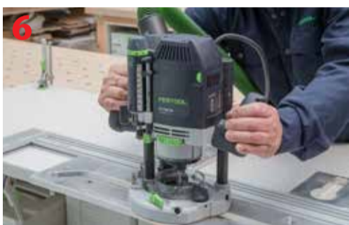
Frezowanie blatu poprzecznego z prawej strony
