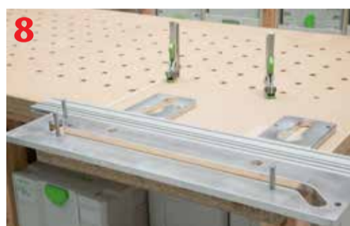
Prawidłowe ustawienie sworzni w szablonie
