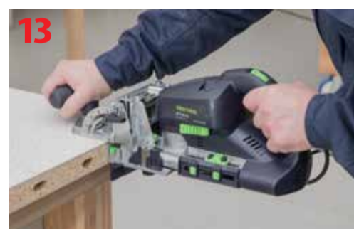
Frezowanie otworów wzdłużnych
