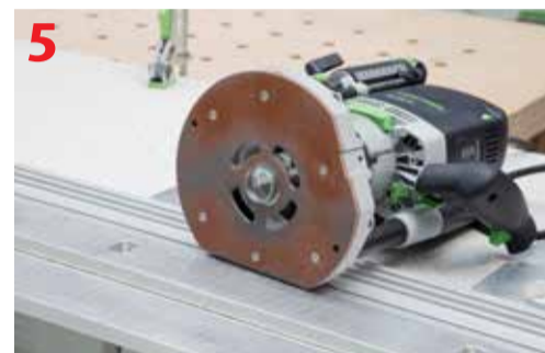
Frezarka Festool OF 2200 EB z pierścieniem kopiującym
