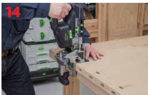
Frezowanie otworów prostopadłych
