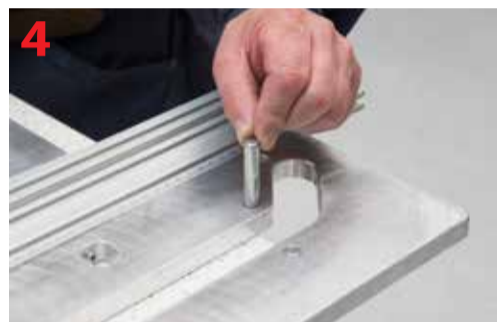
Montaż sworzni ustalających
