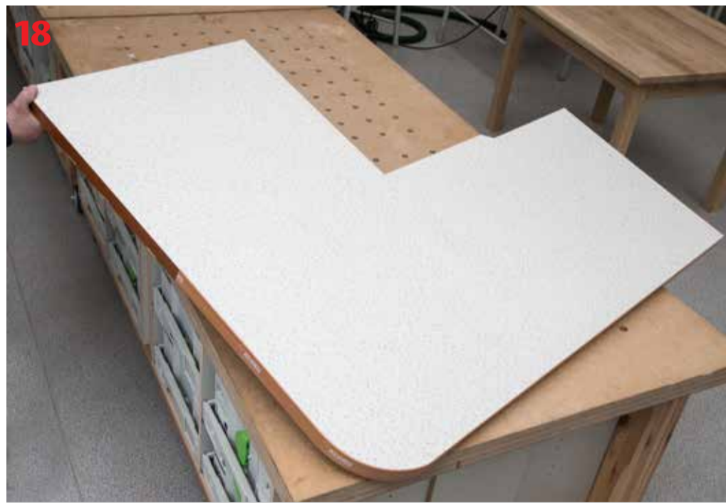
Prawidłowo połączone blaty za pomocą systemu rozłącznych łączników Domino
