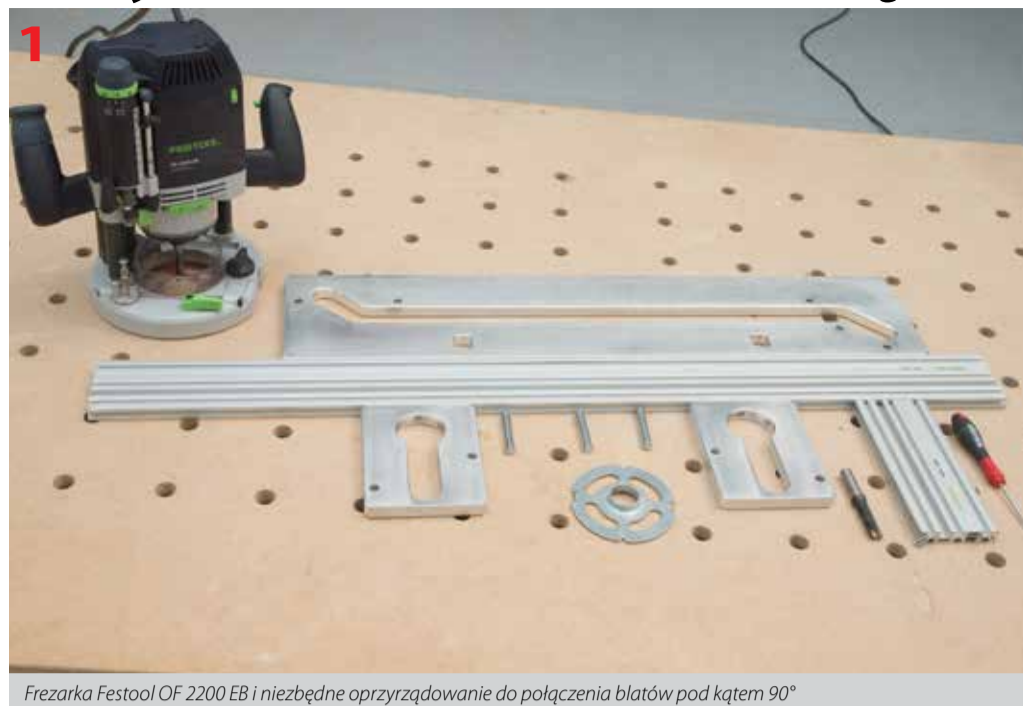
Frezarka Festool OF 2200 EB i niezbędne oprzyrządowanie do połączenia blatów pod kątem 90°
