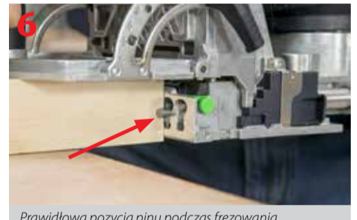
Prawidłowa pozycja pinu podczas frezowania pierwszego gniazda
