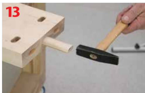
Montaż bukowego łącznika Domino
