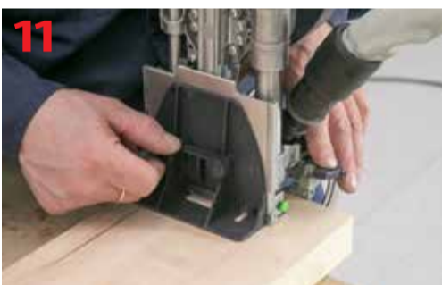
Montaż podparcia kąowego stolika
