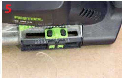
Ustawienie głębokości frezowania na 50 mm
