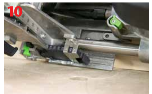
Prawidłowo ustawiony stolik do frezowania pionowego
