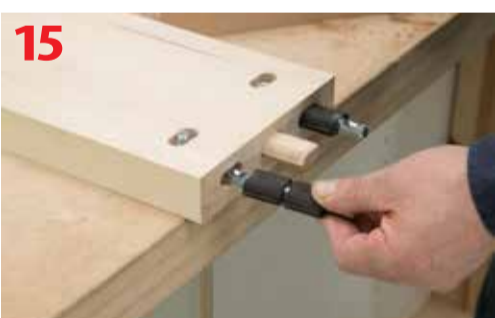
Montaż sworzni kotwiących Domino z półosłonami
