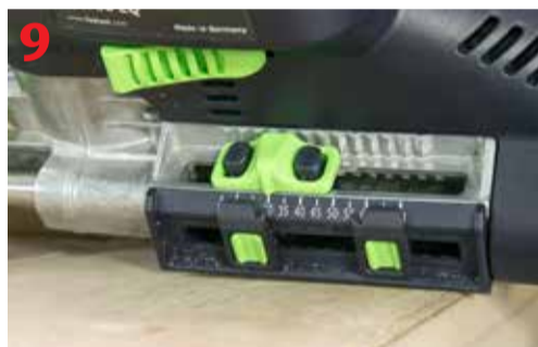
Ustawiona na 30 mm głębokość frezowania pionowego
