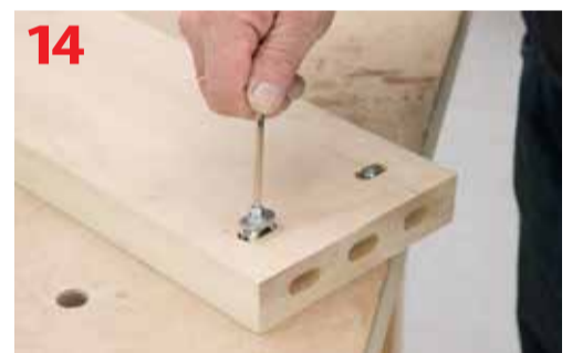
Montaż kotew poprzecznych
