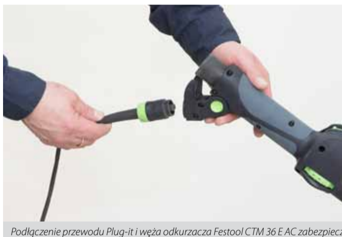
Podłączenie przewodu Plug-it i węża odkurzacza Festool CTM 36 E AC zabezpieczonego mufą przed rozłączeniem
