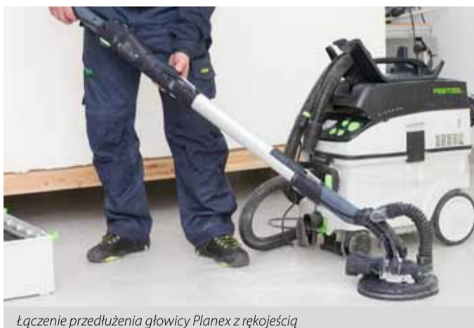
Łączenie przedłużenia głowicy Planex z rękojścią
