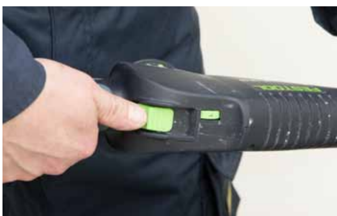
Włacznik główny szlifierki i pokrętło regulacji obrotów
