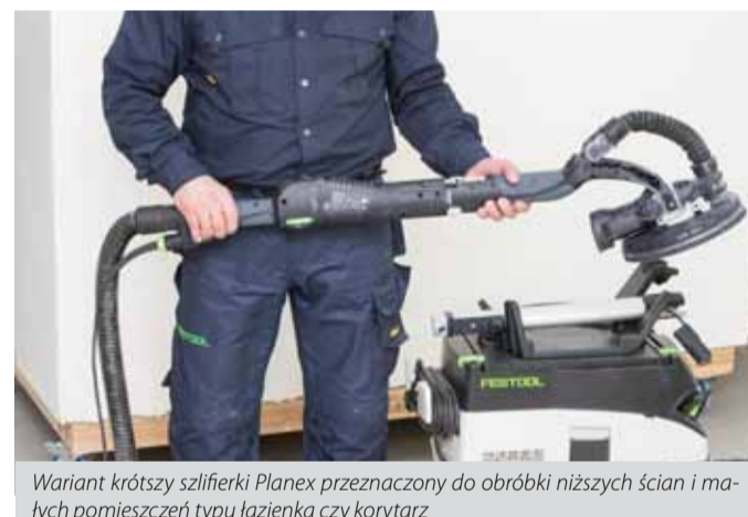
Podłączenie przewodu Plug-it i węża odkurzacza Festool CTM 36 E AC zabezpieczonego mufą przed rozłączeniem
