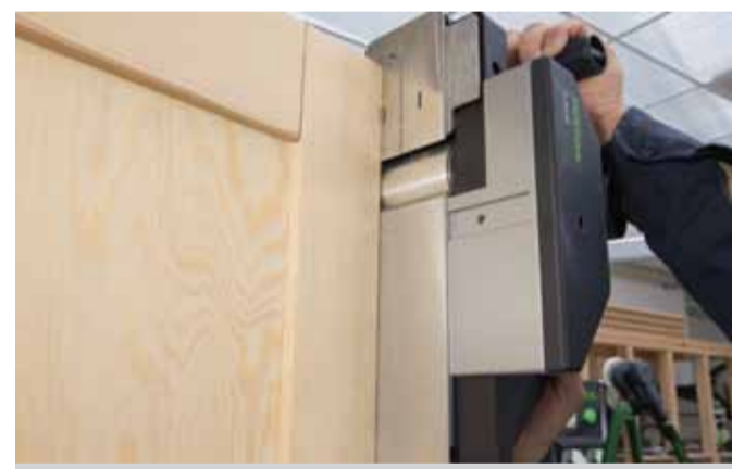
Jedno z zastosowań struga przy montażu stolarki otworowej
