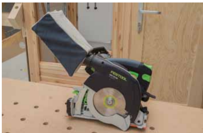
Pilarka HKC z workiem i opuszczoną osłoną wahadłową do pracy z wolnej ręki
