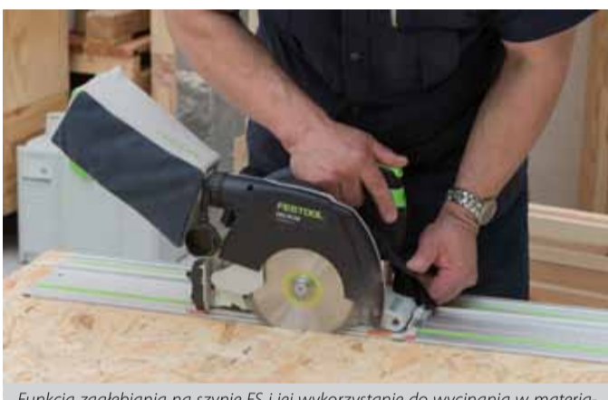
Funkcja zagłębienia na szynie FS i jej wykorzystanie do wycinania w materiałach płytowych
