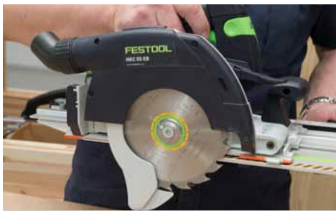
Odchylona osłona i klin stanowiący jej część oraz okienko kontrolne i wskaźnik cięcia (pomarańczowy pasek na stoliku pilarki)
