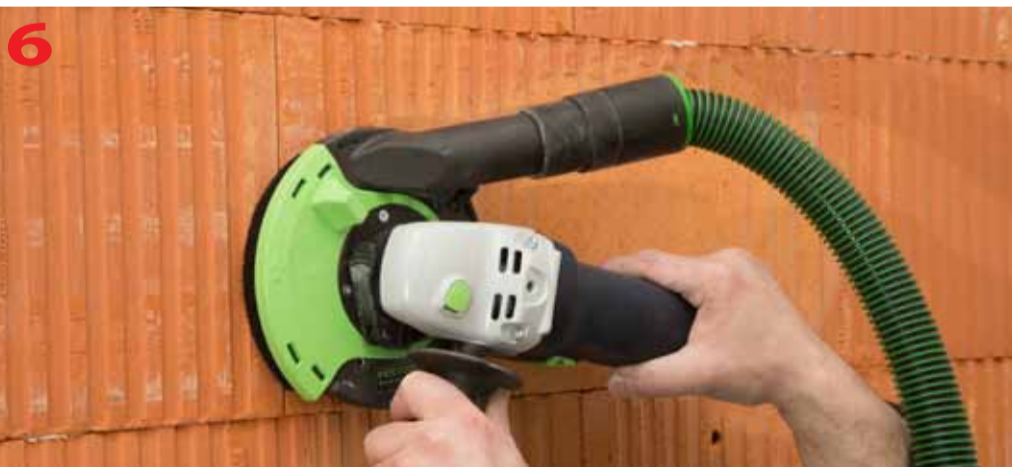
Efektywne odsysanie pyłu – maszyna uzbrojona w osłonę z króćcem do odkurzacza służącą do pracy z diamentowymi tarczami do szlifowania
