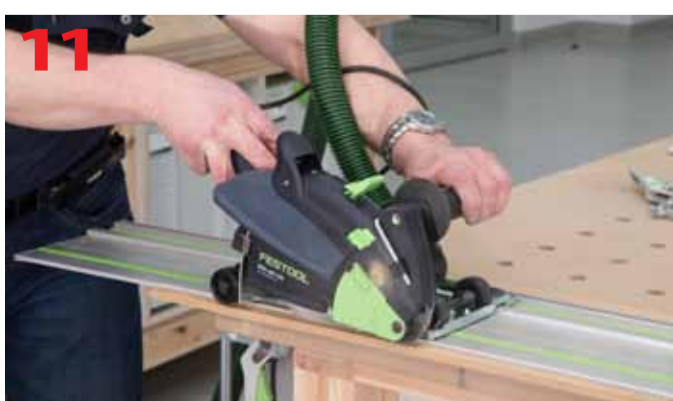
Cięcie materiałów cementowo włóknowych
