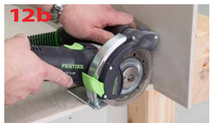
Cięcie płytki gresowej po linii prostej z przewodnicą FS
