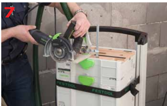
Łatwe cięcie elementów małowymiarowych z wykorzystaniem Systainera MFT
