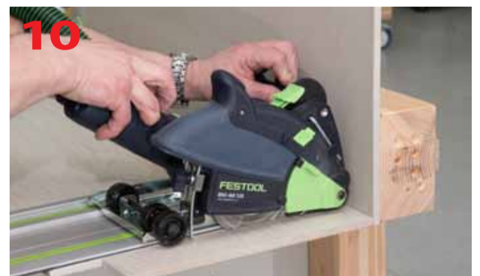
Cięcie płytki gresowej po linii prostej z przewodnicą FS
