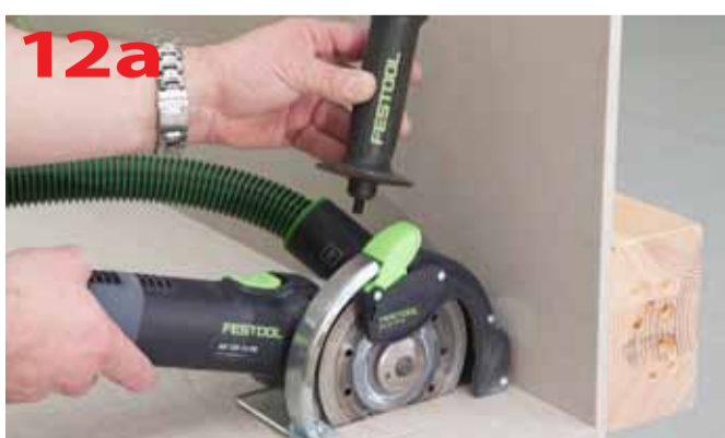
Efekt bliskiego dojścia do ściany po odchyleniu osłony (w tym celu należy zdemontować rękojeść dodatkową)
