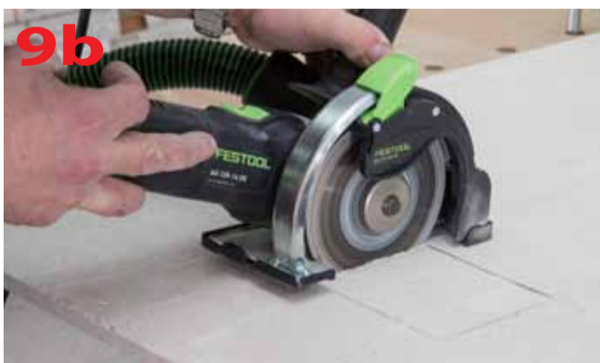
Dodatkowa osłona zabezpieczająca stół prowadzący
