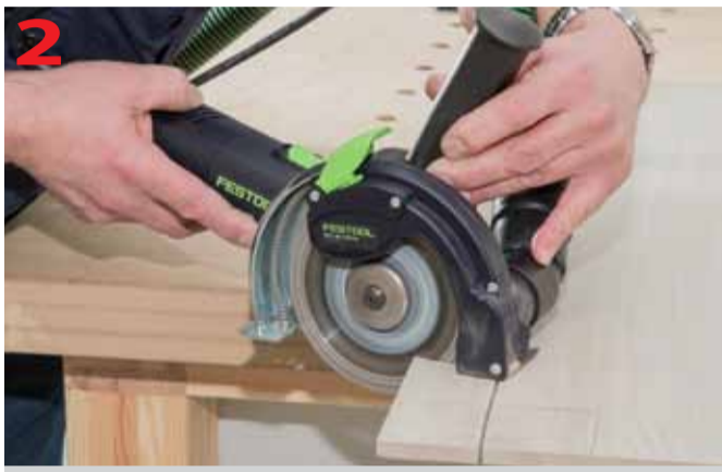
Cięcie gresu według wytrasowanych linii
