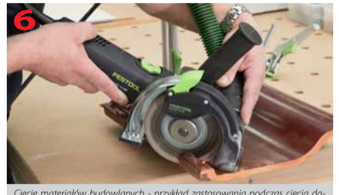
Cięcie materiałów budowlanych - przykład zastosowania podczas cięcia dachówki ceramicznej
