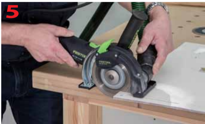
Cięcie laminatu zbrojonego włóknem szklanym
