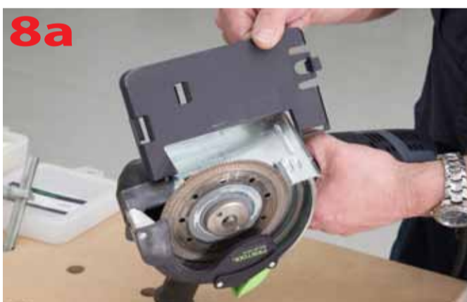
Dodatkowa osłona zabezpieczająca stół prowadzący
