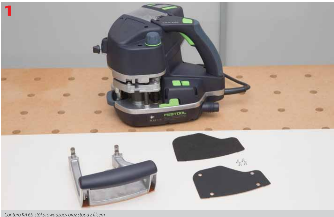
Conturo KA 65, stół prowadzący oraz stopa z filcem
