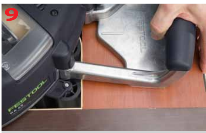
Okleinywanie kąta wewnętrznego. Od prawej do lewej strony
