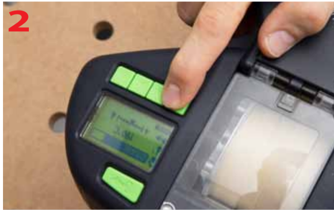
Zmiana ustawień okleiniarki CONTURO KA 65
