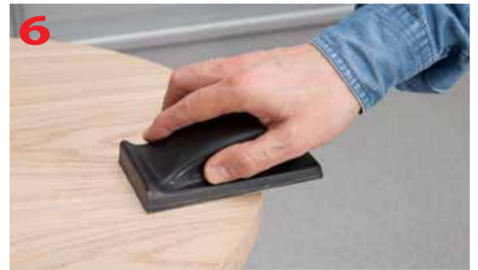
Wyrównywanie krawędzi forniru przy użyciu klocka szlifierskiego
