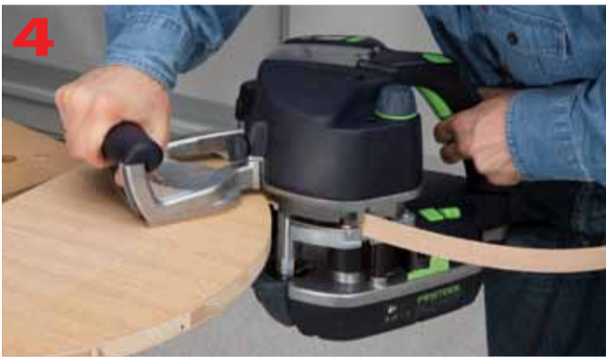
Prowadzenie CONTURO podczas naklejania obrzeża
