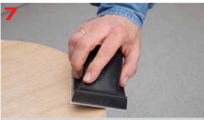
Lekkie fazowanie krawędzi forniru przy użyciu klocka szlifierskiego
