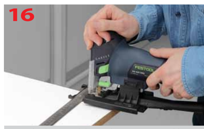
Wyrzynarka uzbrojona w cyrkiel, gotowa do rozpoczęcia wycinania łuku kołowego
