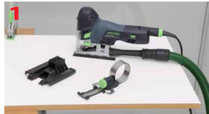
Wyrzynarka PS 420 EBQ z wyposażeniem do wycinania łuku kołowego
