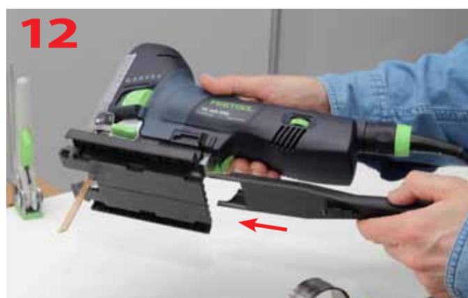
Wsuwanie króca ssącego od tyłu stołu wyrzynarki
