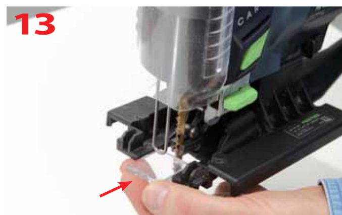
Wsuwanie zabezpieczenia przeciwodpryskowego od przodu stołu wyrzynarki
