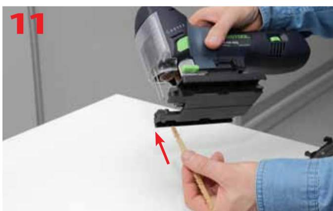
Mocowanie brzeszczotu w tulei zaciskowej poprzez wciśnięcie i przekręcenie go
