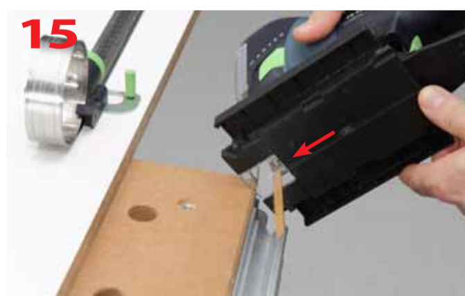
Wcięcie brzeszczotu w płytkę zabezpieczenia przeciwodpryskowego
