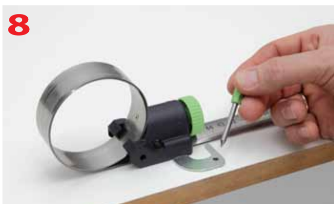
Osadzanie szpicu stanowiącego oś obrotu cyrkla w otworze
