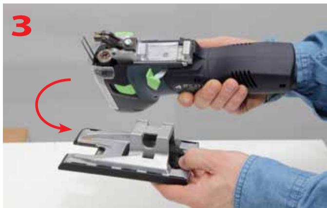
Zdejmowanie stopy z korpusu wyrzynarki po odblokowaniu dźwigni
