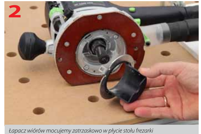
Łapacz wiórów mocujemy zatraskowo w płycie stołu frezarki
