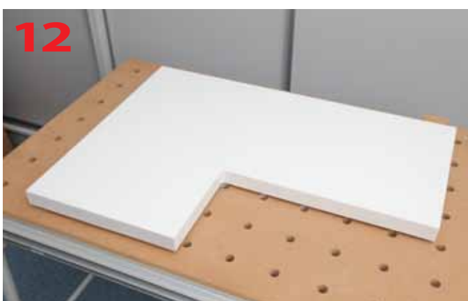
Sprawdzenie dokładności przylegania elementów
