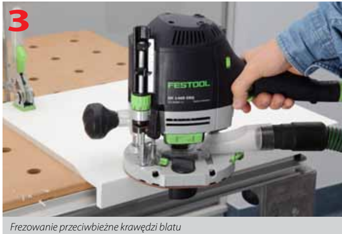
Frezowanie przeciwbieżne krawędzi blatu
