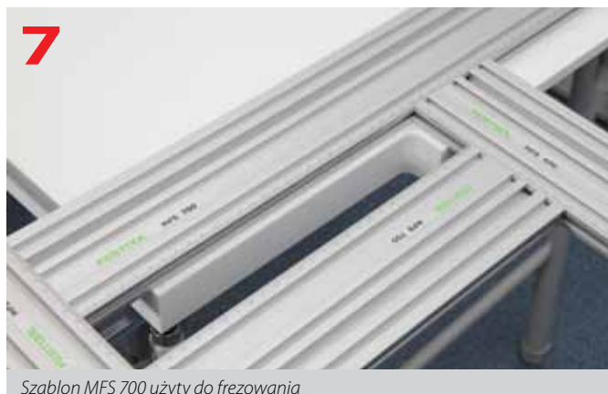
Szablon MFS 700 użyty do frezowania
