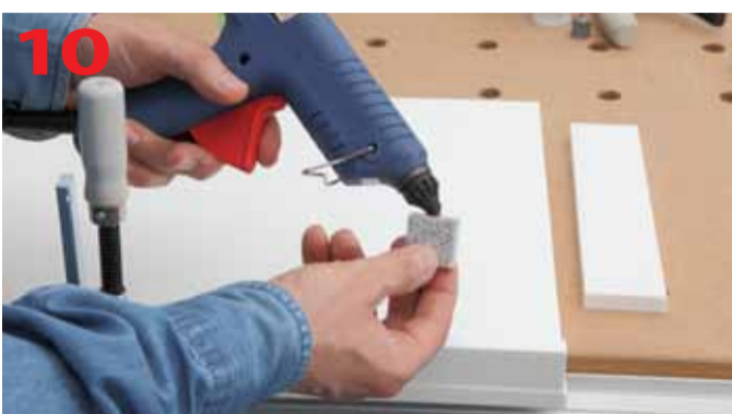
Przyklejanie klocków pomocniczych ustalających położenie podklejek
