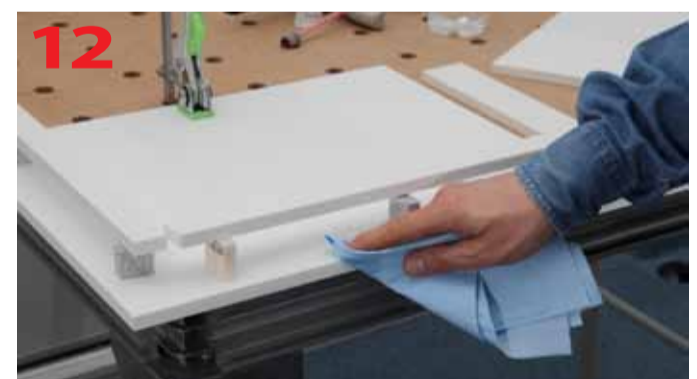
Czyszczenie powierzchni klejenia szmatką nasączoną alkoholem etylowym
