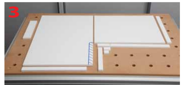
Płaszczyzny blatu i podklejki docięte na odpowiednie wymiary
