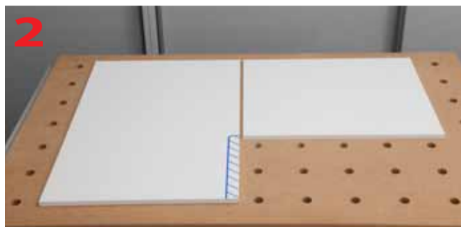
Elementy powierzchni blatu docięte pilarką TS 55 REBQ
