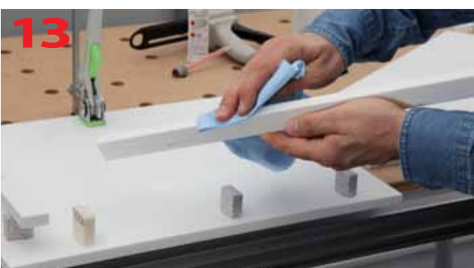
Czyszczenie krawędzi podklejki
