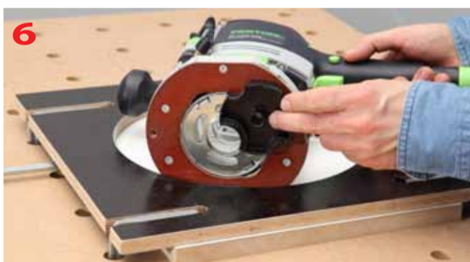
Element podpierający stolik maszyny na materiale wykorzystany w celu dokładnego prowadzenia frezarki
