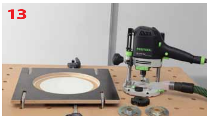
Stanowisko pracy po wykonaniu drugiego etapu frezowania
