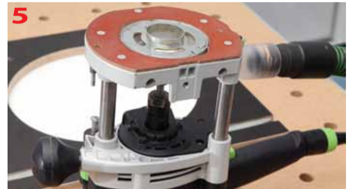
Frezarka OF 1400 EBQ z zamocowanym frezem i pierścieniem kopiującym
