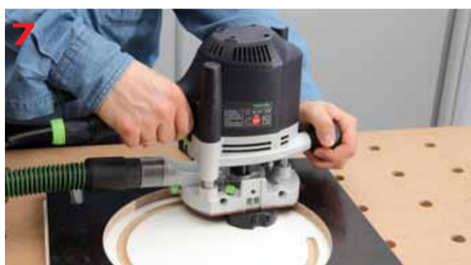
Frezowanie po krawędzi szablonu zgodnie z ruchem wskazówek zegara
