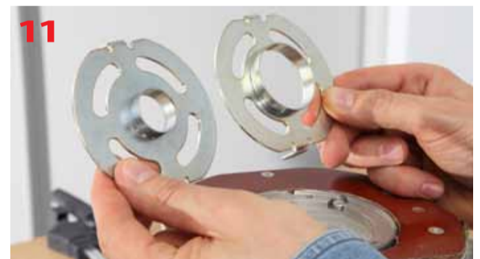
Pierścień kopiujący wykorzystywany w obu etapach prac
