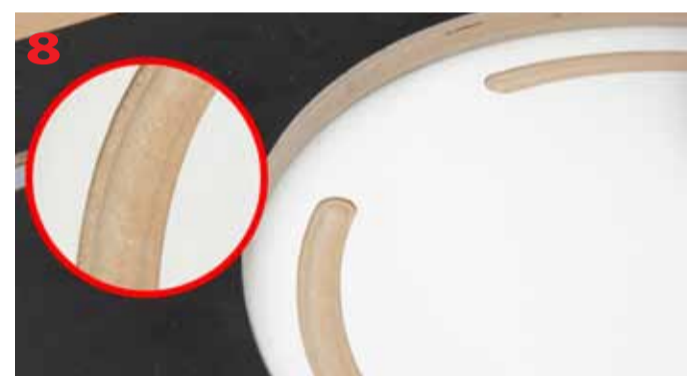
Pojedynczy wzór wyfrezowania profilowego uzyskany w pierwszym etapie pracy
