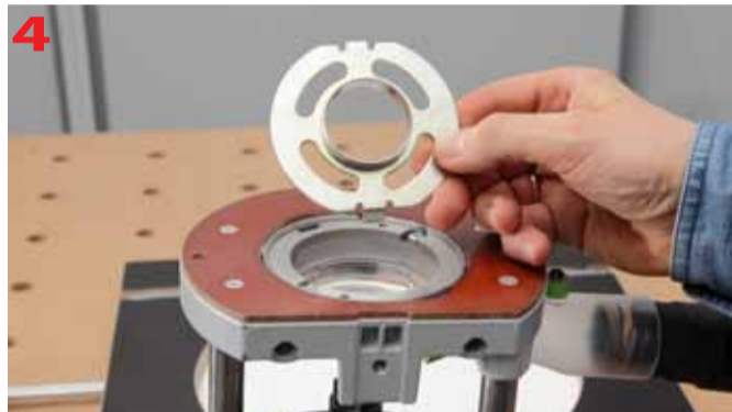
Pierścień kopiujący D 40 mm wykorzystany do frezowania pierwszego okręgu
