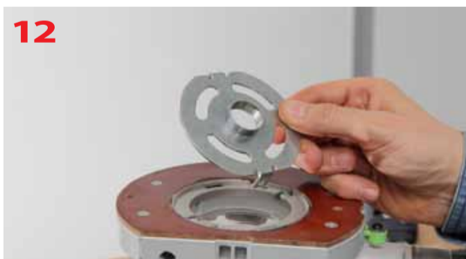
Pierścień kopiujący D 24 mm przygotowany do zamocowania w stoliku frezarki OF 1400 EBQ
