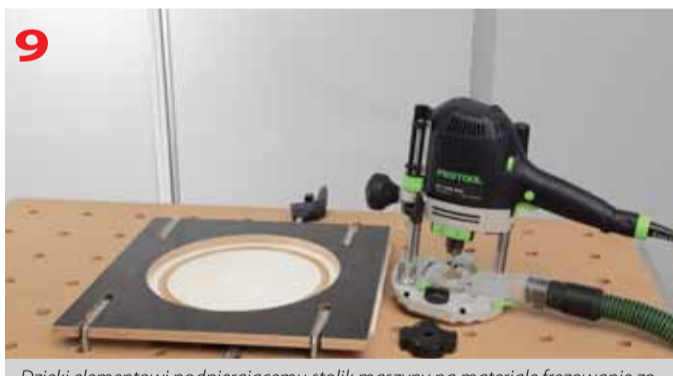
Dzięki elementowi podpierającemu stolik maszyny na materiale frezowanie zostało wykonane bardzo precyzyjnie
