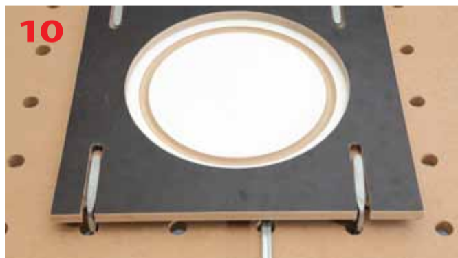
Gotowy wzór zdobienia elementu wykonany w pierwszym etapie pracy
