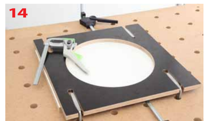
Szablon przygotowany do frezowania okręgu na płaszczyźnie elementu
