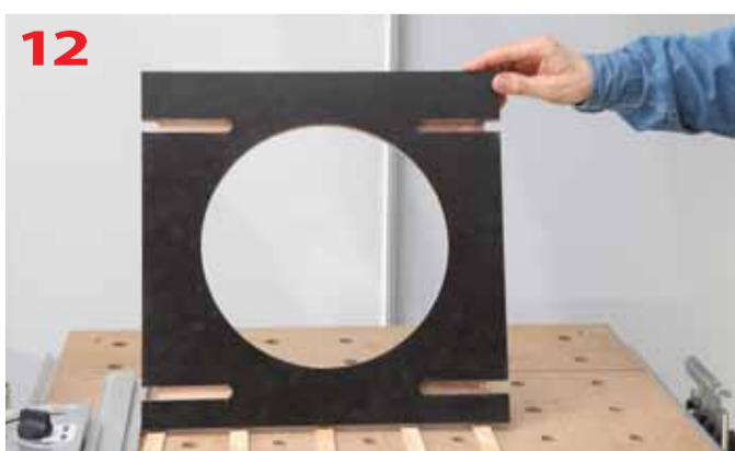
Szablon do frezowania okręgów wykonany ze sklejki
