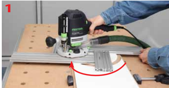
Frezowanie okręgu na płaszczyźnie elementu
