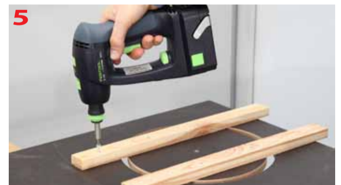
Odkręcamy listwy stabilizujące
