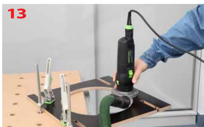
Zaokrąglenie krawędzi szablonu za pomocą frezarki OFK 500 Q
