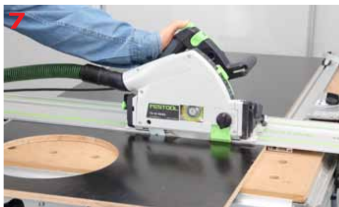
Arkusz z wyfrezowanym otworem docinamy za pomocą pilarki zagłębiarki
