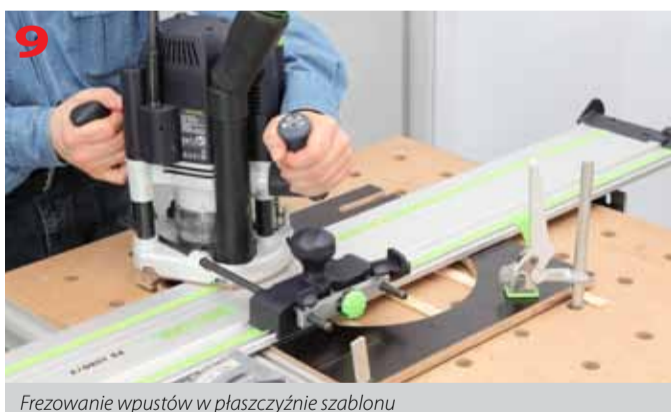
Okrąg wewnętrzny został również precyzyjnie wyfrezowany
