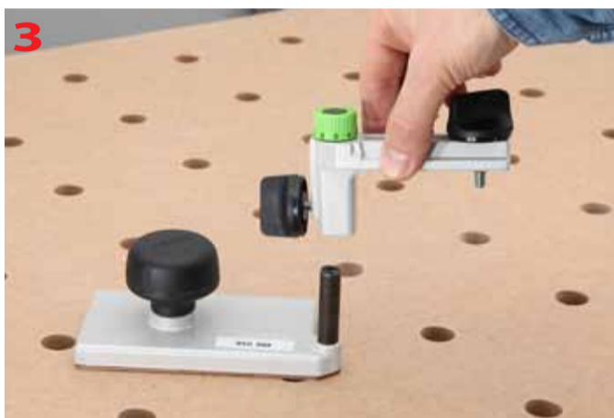
Płyta do frezowania doklejek współpracująca z ramieniem kątowym
