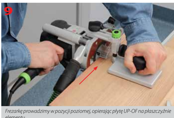
Po ustawieniu poziomej pozycji płyty dokręcamy śrubę mocującą C
