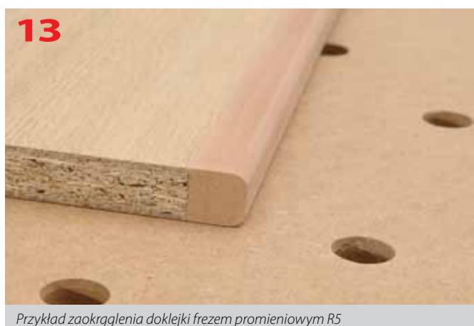
Zastosowanie proponowanego rozwiązania pozwala na bardzo precyzyjne frezowanie doklejki
