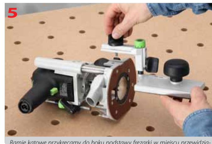
Ramię kątowe przykręcamy do boku podstawy frezarki w miejscu przewidzianym do mocowania wyposażenia
