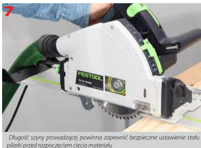
Pokrętkami mimosłownikowymi regulujemy precyzyjne prowadzenie pilarki po szynie
