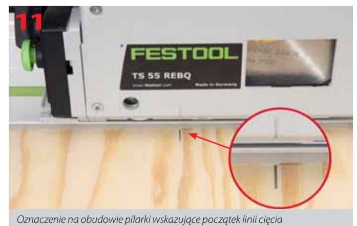
Rozpoczęcie cięcia materiału w środku arkusza bez odpowiedniego wyposażenia dodatkowego jest niebezpieczne, ponieważ może spowodować utratę kontroli nad prowadzeniem maszyny
