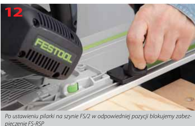
Zabezpieczenie przed cofaniem piły FS-RSP mocujemy w rowku prowadzącym szyny FS/2
