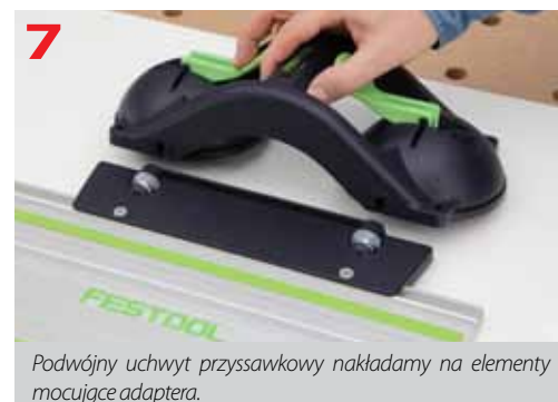
Do zamocowania tego końca szyny użyjemy zestawu GECKO DOSH-Set.
