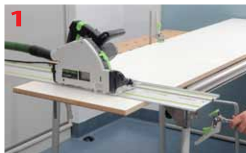
Mocowanie szyny prowadzącej na materiale przy użyciu dwóch ścisków dźwigniowych FS-HZ 160
