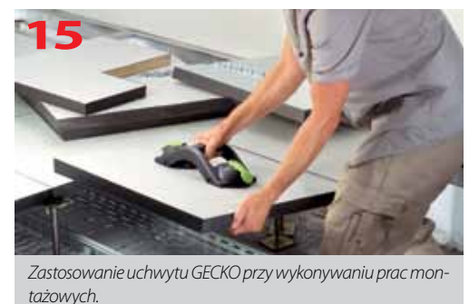
Uchwyty przyssawkowe GECKO zastosowane do przenoszenia arkusza płyty laminowanej.
