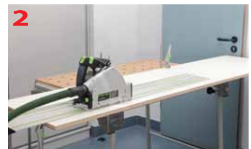
W tym przypadku zamocowanie prawego końca szyny metodą tradycyjną nie jest możliwe.
