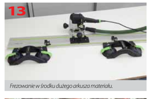
Przekręcając dźwignię powodujemy przyssanie się talerza uchwytu do płaszczyzny elementu.
