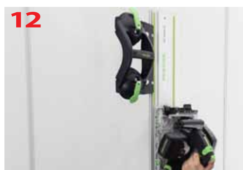
Dokręcając dwa pokręta adaptera, łączymy z nim uchwyt przyssawkowy.
