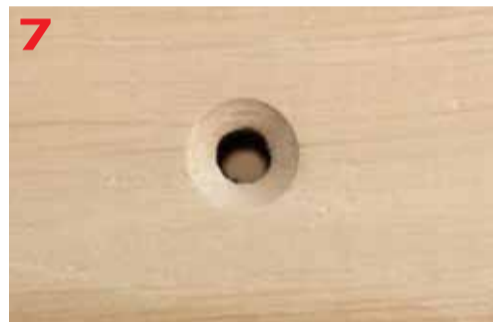
Otwór z wykonaną fazą
