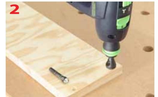
Fazowanie otworów o różnych średnicach
