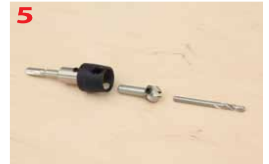
Elementy składowe nawiertaka z ogranicznikiem głębokości
