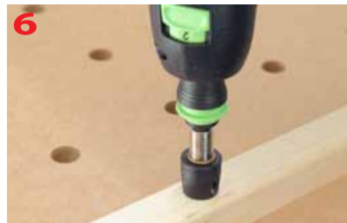
Wiercenie otworu z jednoczesnym wykonywaniem fazy
