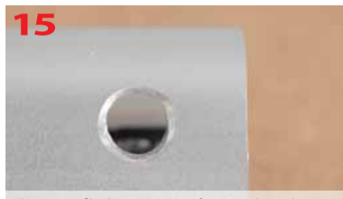
Otwór w profilu aluminiowym po sfazowaniu krawędzi
