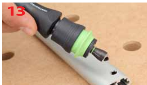
Wiertło fazujące dobrane do średnicy otworu
