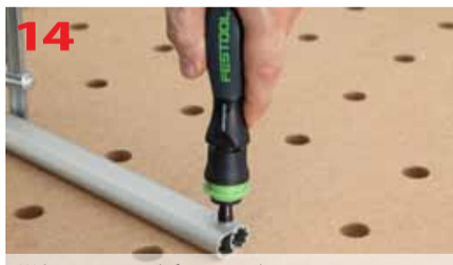
Wykorzystanie wiertła fazującego do pracy ręcznej
