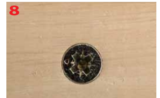
Główka wkręta dokładnie pasuje do sfazowanego otworu
