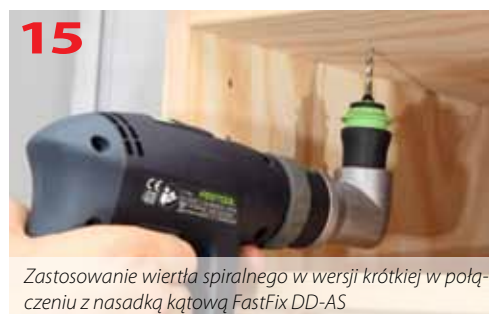
Wiertła spiralne do drewna dostępne są w wersji standardowej oraz krótkiej
