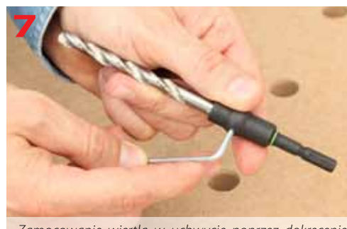
Zamocowanie wiertła w uchwycie poprzez dokręcenie śruby
