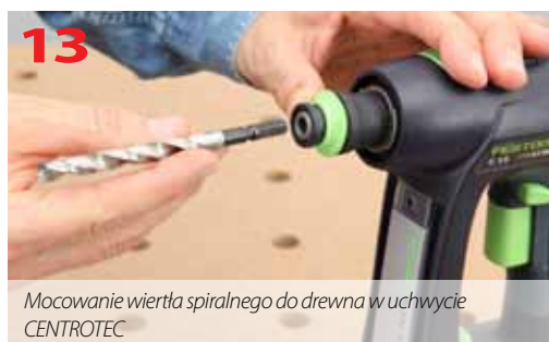
Wiertło spiralne HSS CE zamocowane w uchwycie CENTROTEC
