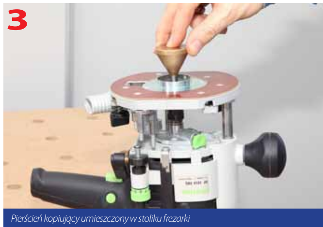
Przygotowanie frezarki OF 1010 EBQ do pracy z pierścieniem kopiującym
