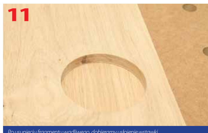
Po usunięciu fragmentu wadliwego, dobieramy usłojenie wstawki
