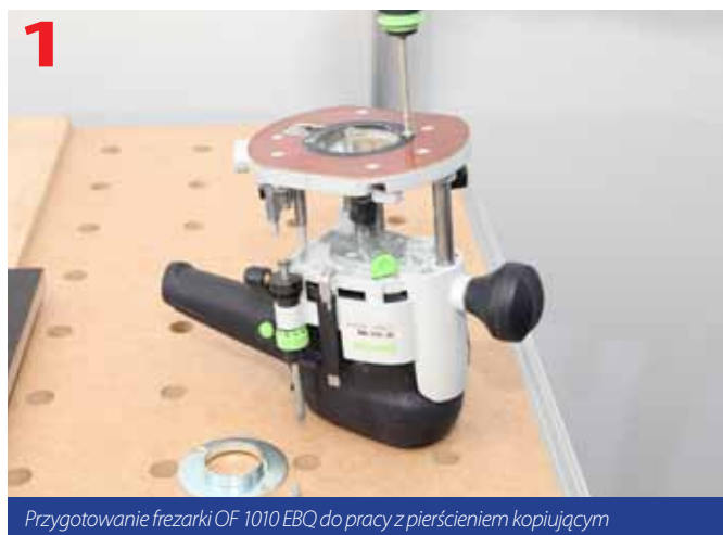
Przygotowanie frezarki OF 1010 EBQ do pracy z pierścieniem kopiującym
