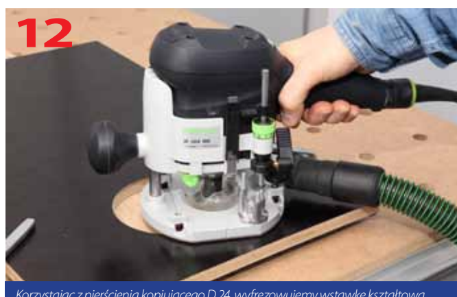
Korzystając z pierścienia kopiującego D 24, wyfrezowujemy wstawkę kształtową
