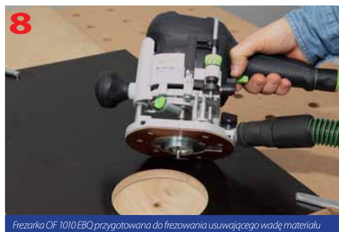
Frezarka OF 1010 EBQ przygotowana do frezowania usuwającego wadę materiału
