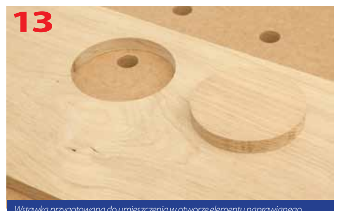
Wstawka przygotowana do umieszczenia w otworze elementu naprawianego
