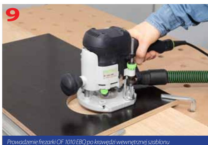
Prowadzenie frezarki OF 1010 EBQ po krawędzi wewnętrznej szablonu
