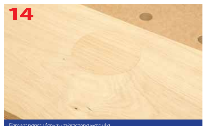
Element naprawiany z umieszczoną wstawką
