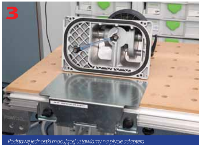
Zestaw podstawowy do mocowania podciśnieniowego VAC SYS Set SE1 rozszerzony o adapter do mocowania na krawędzi stołu MFT/3
