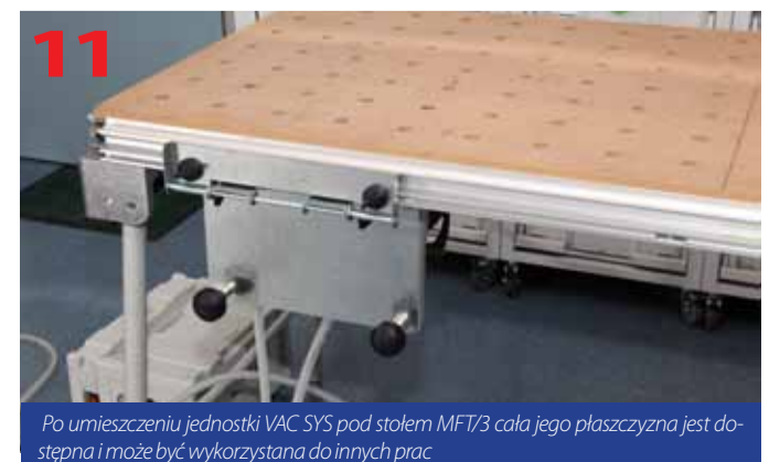
Dzięki funkcji obracania adaptera jednostkę VAC SYS możemy umieścić pod stołem
