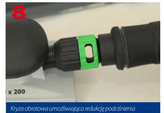
Kryza obrotowa umożliwiająca redukcję podciśnienia
