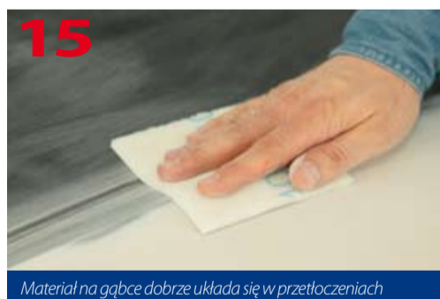
Kłoczek HSK-D 150 W o strukturze miękkiej przydatny do szlifowania przetłoczeń
