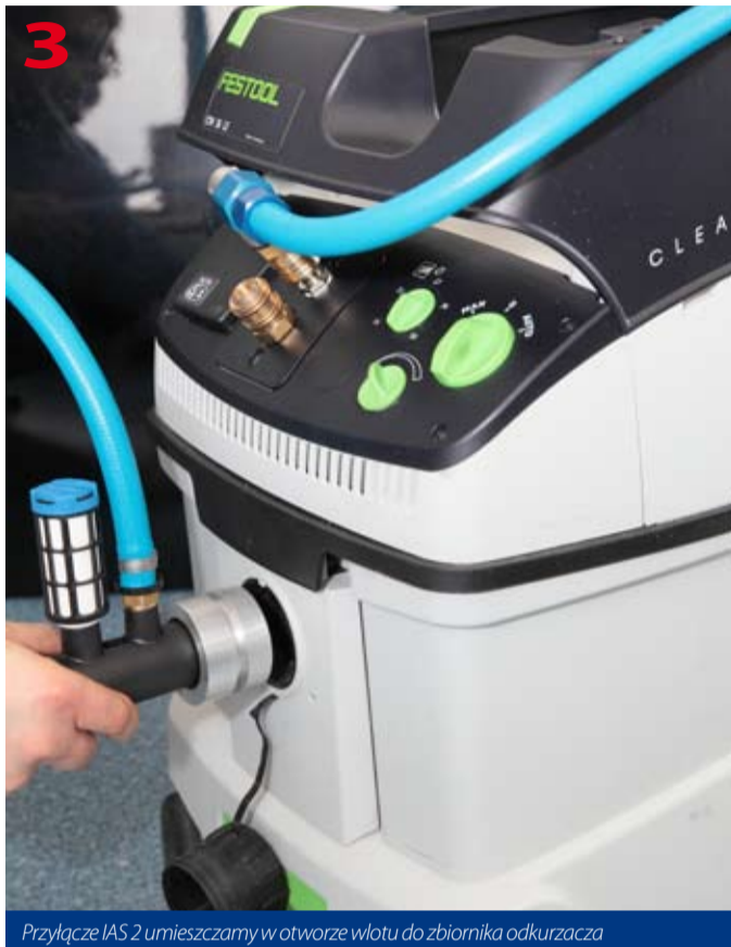
Przyłącze IAS 2 umieszczamy w otworze wlotu do zbiornika odkurzacza
