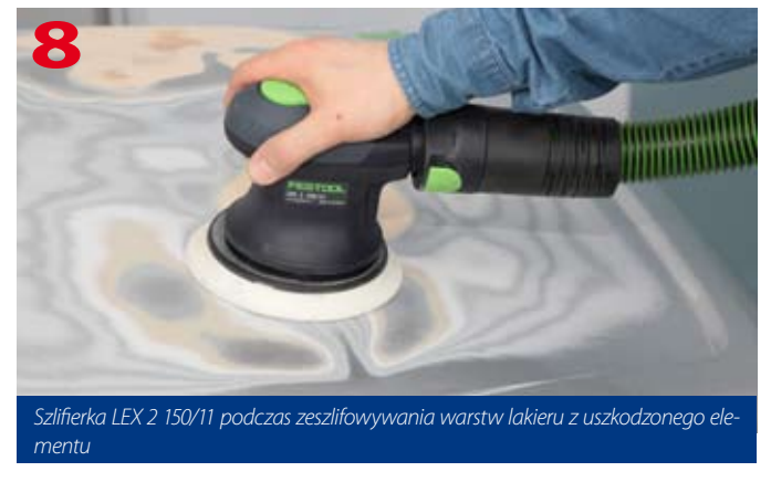
Szlifierka podłączona do węża IAS 2
