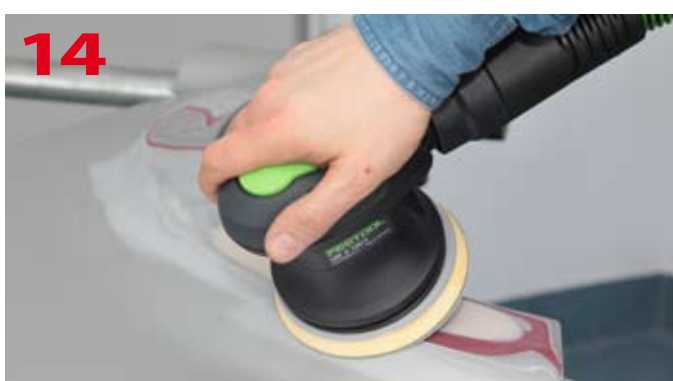
Szlifierka LEX 2 125/3 podczas rozszlifowywania lakieru na niewielkiej powierzchni wypukłej
