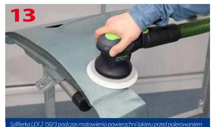
Szlifierka LEX 2 150/3 podczas matowienia powierzchni lakieru przed polerowaniem
