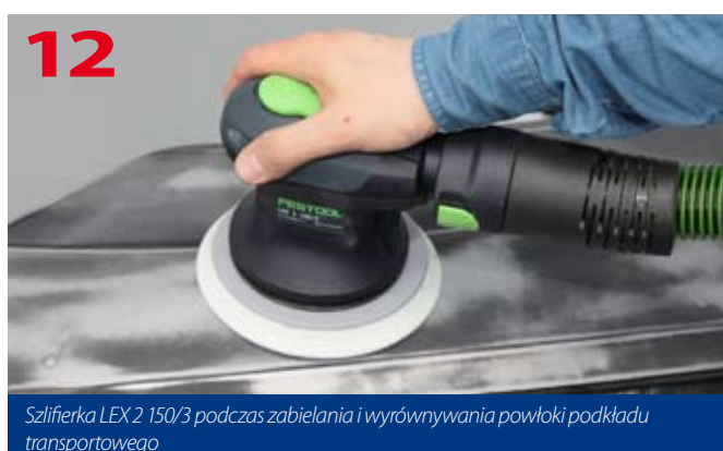
Szlifierka LEX 2 150/7 podczas szlifowania zgrubnego i wyrównywania powierzchni uszkodzonego elementu
