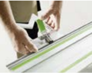
Docinanie płyt pod kątem 90° Wystarczy ustawić przykładnicę kątową FS-WA/90° i zamocować szynę prowadzącą – gotowe! Dzięki temu docinanie płyt pod kątem prostym jest zawsze udane i precyzyjne.
