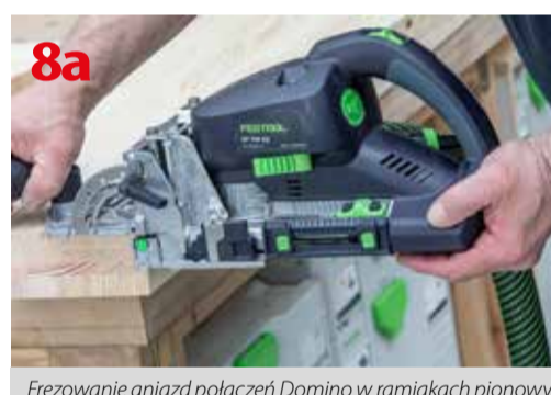
Frezowanie gniazd połączeń Domino w ramiakach pionowych z użyciem frezarki Festool Domino DF 700
