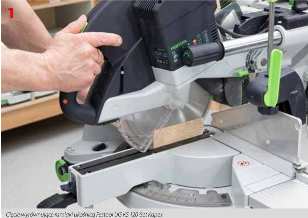
Cięcie ramiaków na wymiar ukośnicą Festool UG KS 120-Set Kapex
