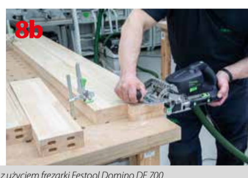
Frezowanie gniazd połączeń Domino w ramiakach pionowych z użyciem frezarki Festool Domino DF 700
