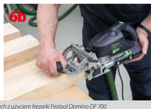
Prawidłowo i dokładnie wycięte ramiaki drzwi zewnętrznych
