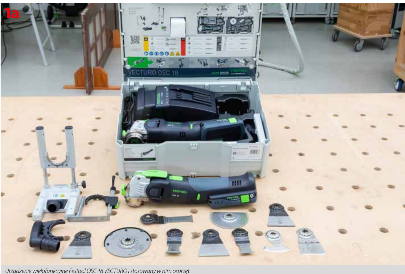
Urządzenie wielofunkcyjne Festool OSC 18 VECTURO i stosowany w nim osprzęt.
