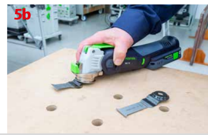
Uchwyt StarlockMAX ze specjalnej konstrukcji szczękami zatraskowymi
