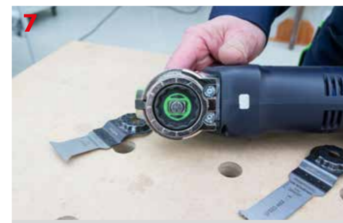
Uchwyt StarlockMAX ze specjalnej konstrukcji szczękami zatraskowymi
