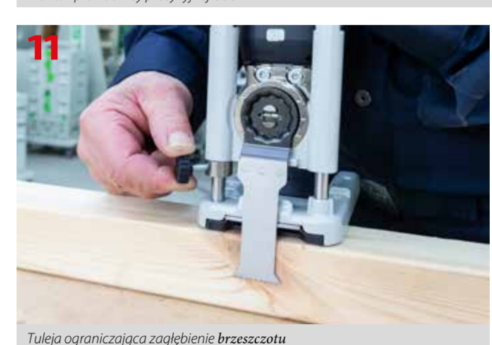
Tuleja ograniczająca zagłębienie brzeszczotu
