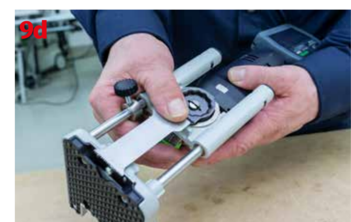
Tuleja ograniczająca zagłębienie brzeszczotu
