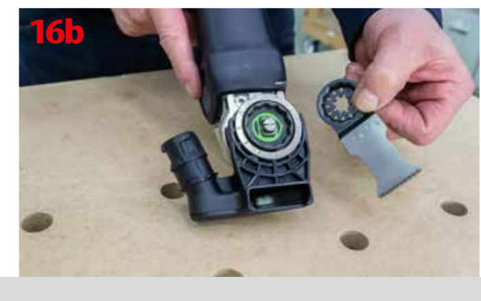
Montaż przyrządu do odsysania OSC-AV
