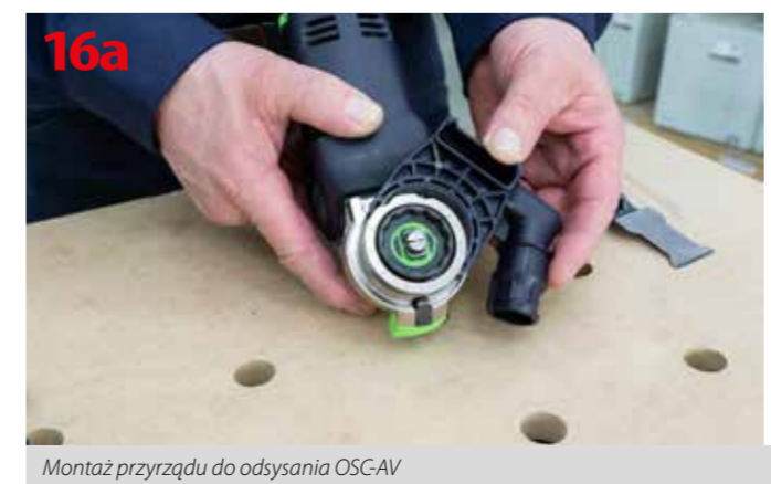
Montaż przyrządu do odsysania OSC-AV
