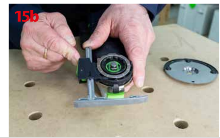
Montaż przyrządu do odsysania OSC-AV
