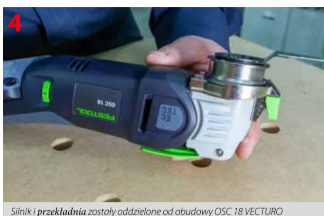
Silnik i przekładnia zostały oddzielone od obudowy OSC 18 VECTURO za pomocą elastycznych wibroizolatorów
