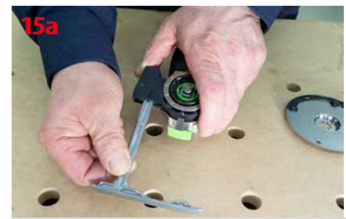
Montaż stopy ślizgowej do długich cięć prostych
