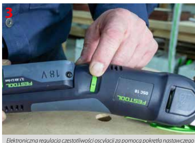
Elektroniczna regulacja częstotliwości oscylacji za pomocą pokrętki nastawczej
