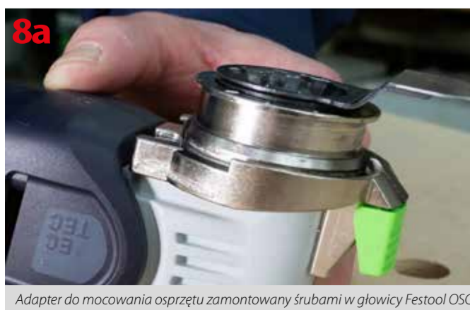
Adapter do mocowania osprzętu zamontowany śrubami w głowicy Festool OSC 18 VECTURO
