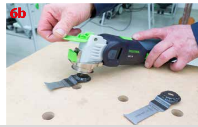
Uchwyt StarlockMAX ze specjalnej konstrukcji szczękami zatraskowymi
