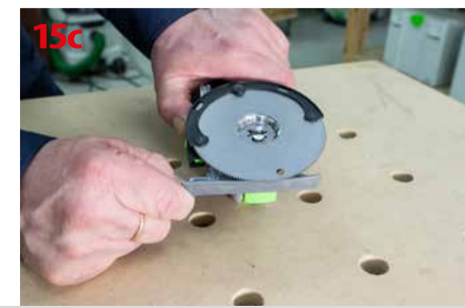
Montaż przyrządu do odsysania OSC-AV
