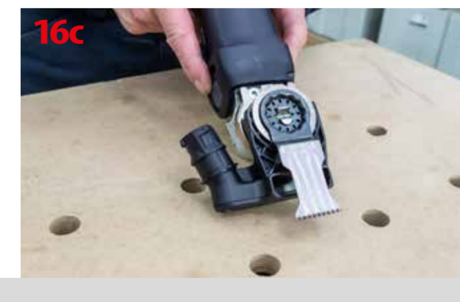
Montaż przyrządu do odsysania OSC-AV
