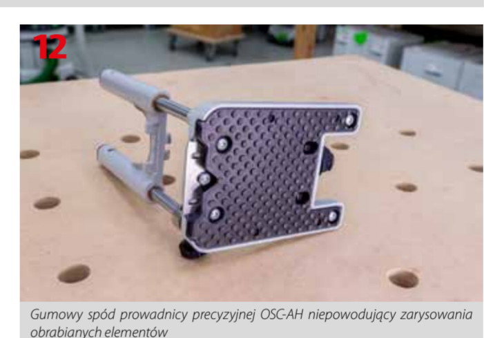
Gumowy spód prowadnicy precyzyjnej OSC-AH niepowodujący zarysowania obrabianych elementów
