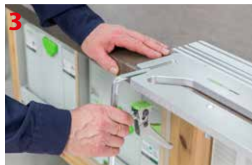
Prawidłowe mocowanie szablonu na obrabianym blacie
