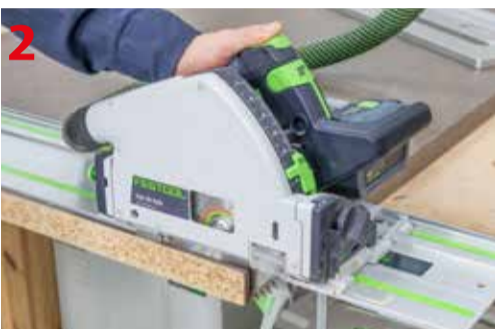
Wyrównanie bocznej krawędzi blatu za pomocą pilarki-zagłębiarki Festool TSC 55 REB
