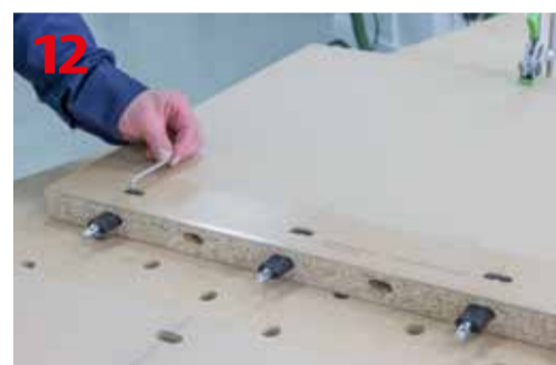
Montaż łączników Domino
