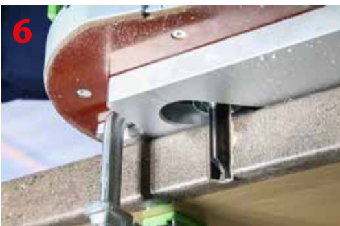
Wstępna obróbka frezarska zaoblonej krawędzi blatu
