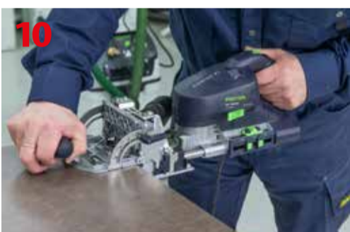
Frezowanie gniazd za pomocą frezarki Festool Domino DF 700
