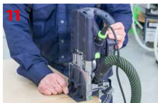
Frezowanie gniazd z użyciem frezarki Festool Domino DF 700
