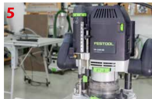
Wstępna obróbka frezarska zaoblonej krawędzi blatu
