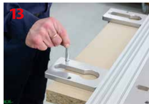
Otwory na sworznie pozycjonujące służące do ustawienia wymiaru frezowania otworów na złączach śrubowych
