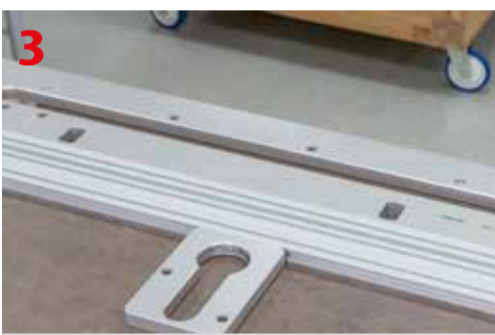
Otwory na sworznie pozycjonujące wykonane w szablonie APS 900/2
