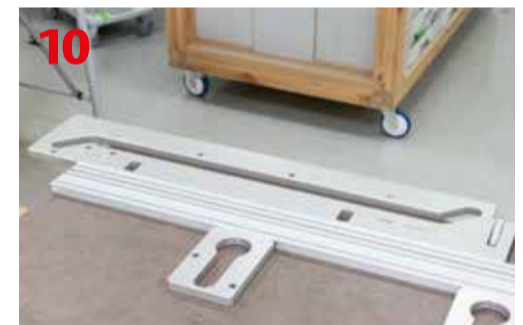
Otwory na sworznie pozycjonujące służące do ustawienia wymiaru frezowania otworów na złączach śrubowych
