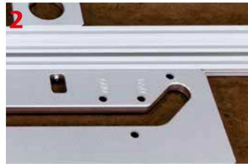
Nowy szablon APS 900/2 pozwala bez przesuwania łączyć blaty o szerokości 650 mm
