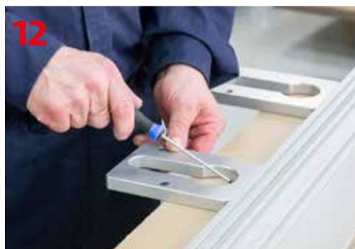
Otwory na sworznie pozycjonujące służące do ustawienia wymiaru frezowania otworów na złączach śrubowych
