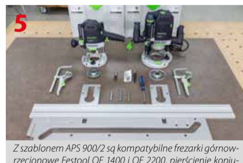
Z szablonem APS 900/2 są kompatybilne frezarki górnozrzecionowe Festool OF 1400 i OF 2200, pierścienie kopiujące D 30 mm, frezy palcowe o średnicy 14 mm z ostrzem węglkowym i systemowe ścisłki mocujące
