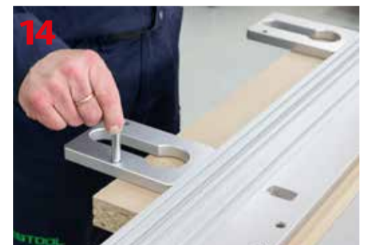
Otwory na sworznie pozycjonujące służące do ustawienia wymiaru frezowania otworów na złączach śrubowych
