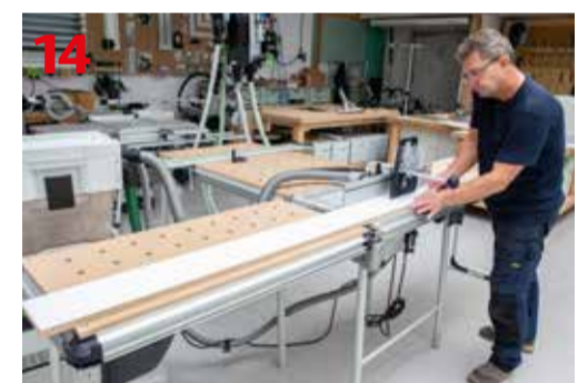
Frezowanie długich elementów meblowych
