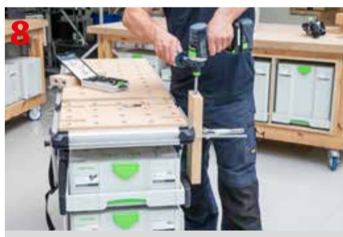
Wiercenie w elementach drewnianych
