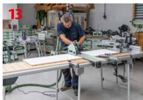
Docinanie długich elementów meblowych
