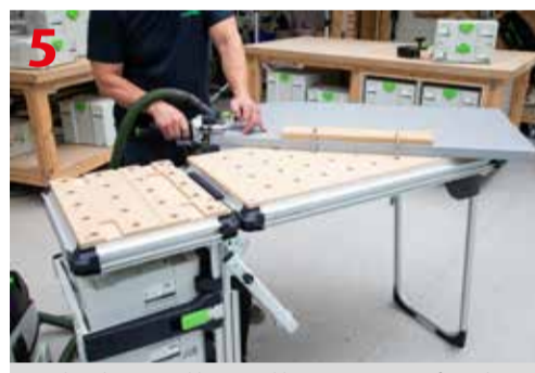
Zaokrąglenie przyklejonej okleiny za pomocą frezarki Festool OFK 700
