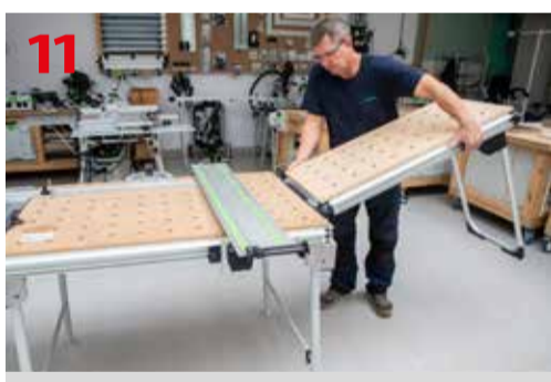
Montaż stolika warsztatowego mobilnego warsztatu Festool MW 1000 w stole MFT/3
