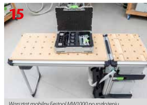
Warsztat mobilny Festool MW1000 po rozłożeniu gotowy do pracy
