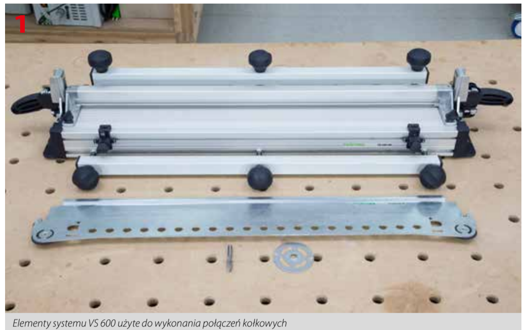
Elementy systemu VS 600 użyte do wykonania połączeń kołkowych
