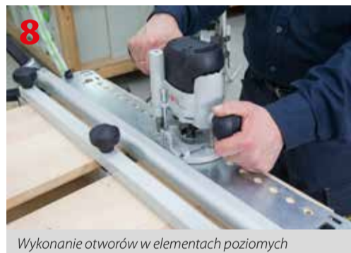
Prawidłowe zamocowanie elementów do frezowania otworów pod kołki za pomocą szablonu DS32
