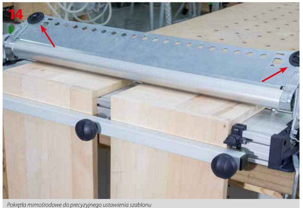
Pokrętła mimośrodowe do precyzyjnego ustawienia szablonu
