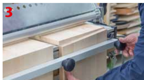
Prawidłowe zamocowanie elementów do frezowania otworów pod kołki za pomocą szablonu DS32
