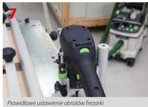
Prawidłowe zamocowanie elementów do frezowania otworów pod kołki za pomocą szablonu DS32
