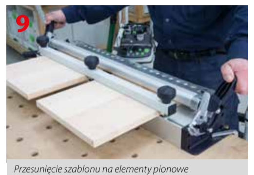
Zwolniona dźwignia mocująca segmenty uchyłne
