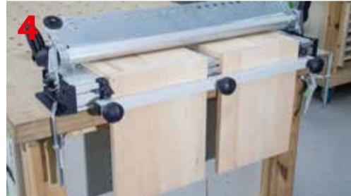
Prawidłowe zamocowanie elementów do frezowania otworów pod kołki za pomocą szablonu DS32
