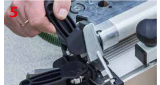
Zwolniona dźwignia mocująca segmenty uchyłne
