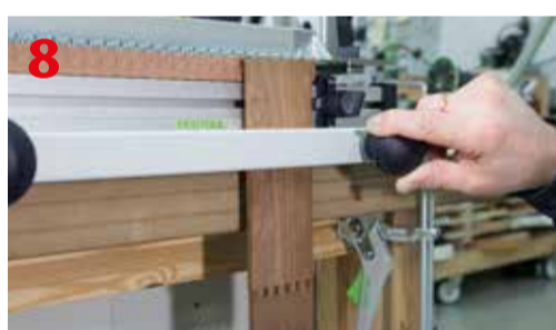
Prawidłowe zamocowanie elementów po ich obróceniu do drugiego frezowania
