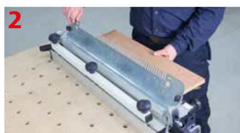
Montaż elementu antyodpryskowego
