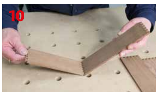
Montaż skrzynki z frezowanych elementów jesionowych
