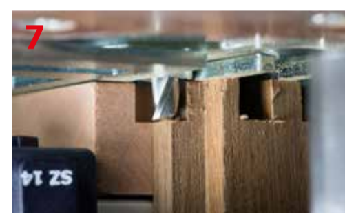
Frezarkę prowadzimy za pomocą pierścienia po szablonie FZ6
