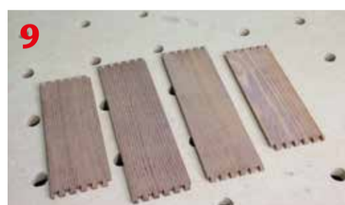
Wyfrezowane elementy z użyciem systemu Festool VS 600
