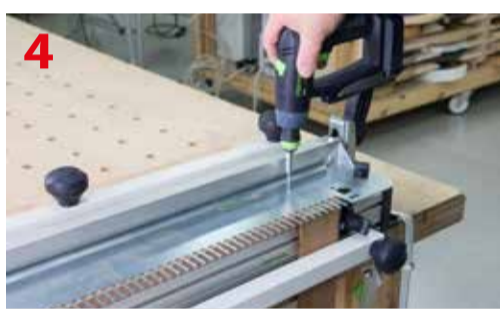
Blokowanie szablonu wkrętami mocowanymi w elemencie antyodpryskowym
