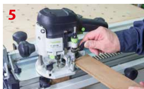
Ustawianie głębokości frezowania
