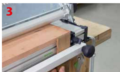
Prawidłowe zamocowanie elementów do frezowania
