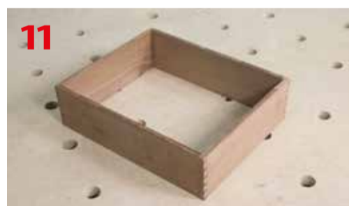
Wykonana skrzynka z frezowanych elementów jesionowych
