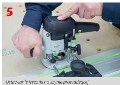
Do frezowania wykorzystuje się frezarki górnowrzecionowe Festool z systemem prowadzenia po szynach, szyny prowadzące i frezy stożkowe 45° lub 90°.
