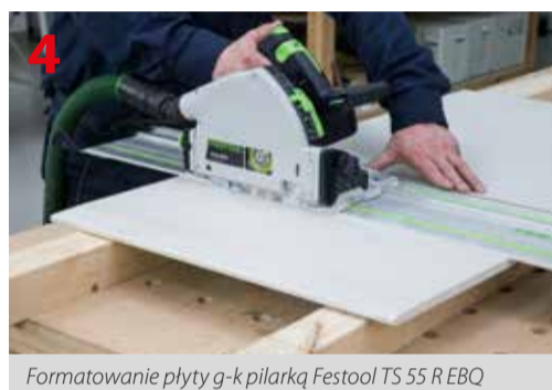
Do cięcia płyt g-k stosuje się pilarkę zagłębiarkę Festool TSC 55 lub TS 55 R, tarcze uniwersalną lub diamentową Festool i szynę prowadzącą Festool
