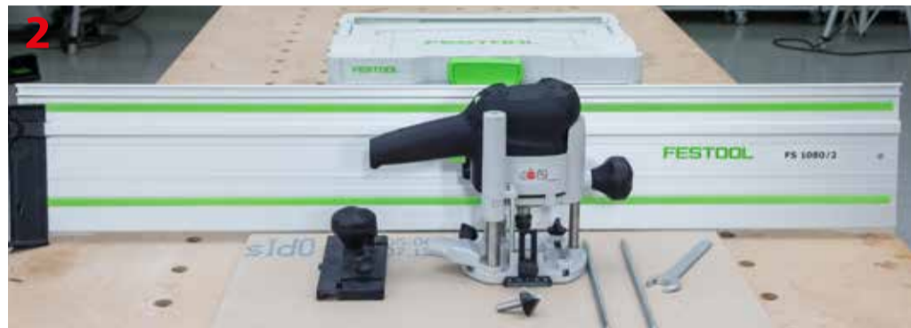
Do frezowania wykorzystuje się frezarki górnowrzecionowe Festool z systemem prowadzenia po szynach, szyny prowadzące i frezy stożkowe 45° lub 90°.
