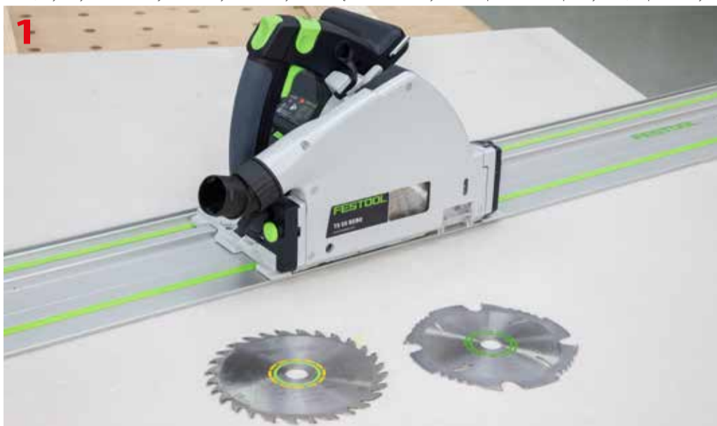
Do cięcia płyt g-k stosuje się pilarkę zagłębiarkę Festool TSC 55 lub TS 55 R, tarcze uniwersalną lub diamentową Festool i szynę prowadzącą Festool
