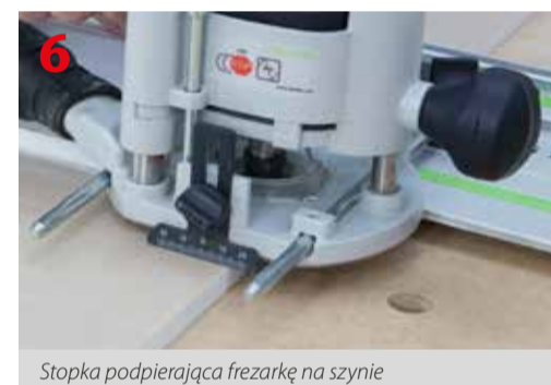
Do frezowania wykorzystuje się frezarki górnowrzecionowe Festool z systemem prowadzenia po szynach, szyny prowadzące i frezy stożkowe 45° lub 90°.
