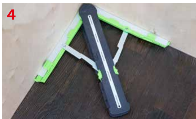
Odwzorowanie kąta wewnętrznego
