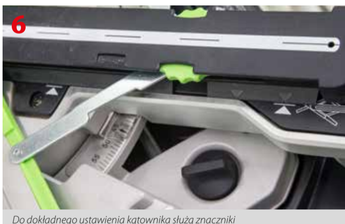
Do dokładnego ustawienia kątownika służą znaczniki
