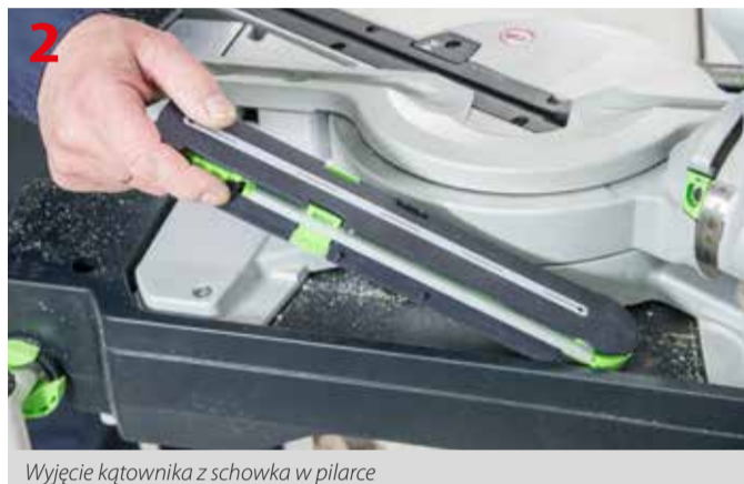
Wyjęcie kątownika z schowka w pilarcie
