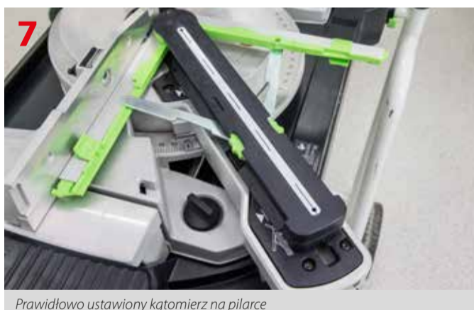
Prawidłowo ustawiony kątomierz na pilarcie
