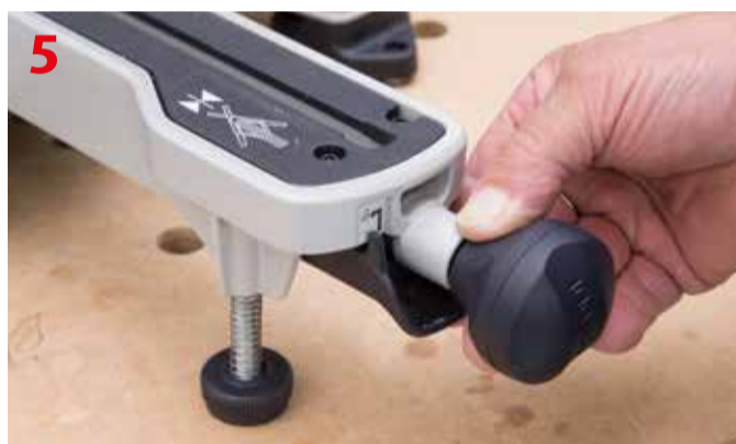
Odblokowanie mechanizmu zapadkowego
