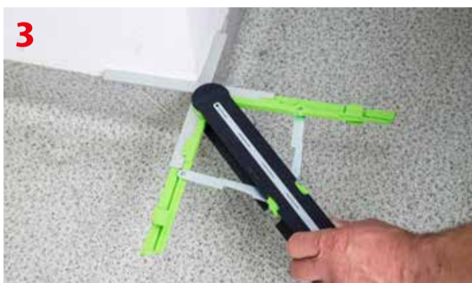
Odwzorowanie kąta zewnętrznego
