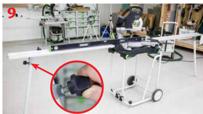
Zestawem przetniemy grube i długie elementy o wymiarach 300 x 60 x 2400 mm
