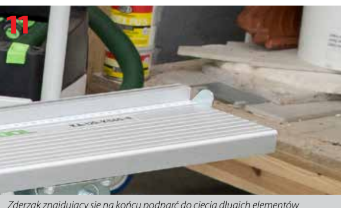
Zderzak znajdujący się na końcu podparć do cięcia długich elementów
