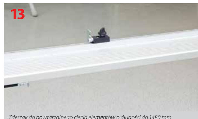
Zderzak do powtarzalnego cięcia elementów o długości do 1480 mm
