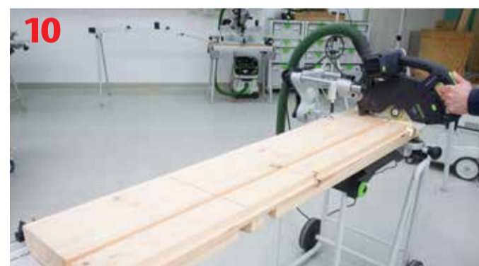
Zderzak do powtarzalnego cięcia elementów o długości do 1480 mm
