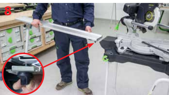
Montaż podparcia, zablokowanie go na płycie adaptera i poziomowanie zestawu
