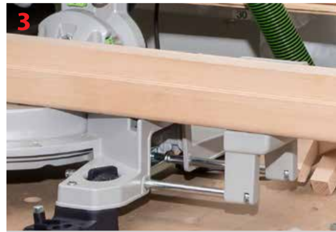
Wysuwane podparcia do materiałów o maksymalnej długości 72 cm
