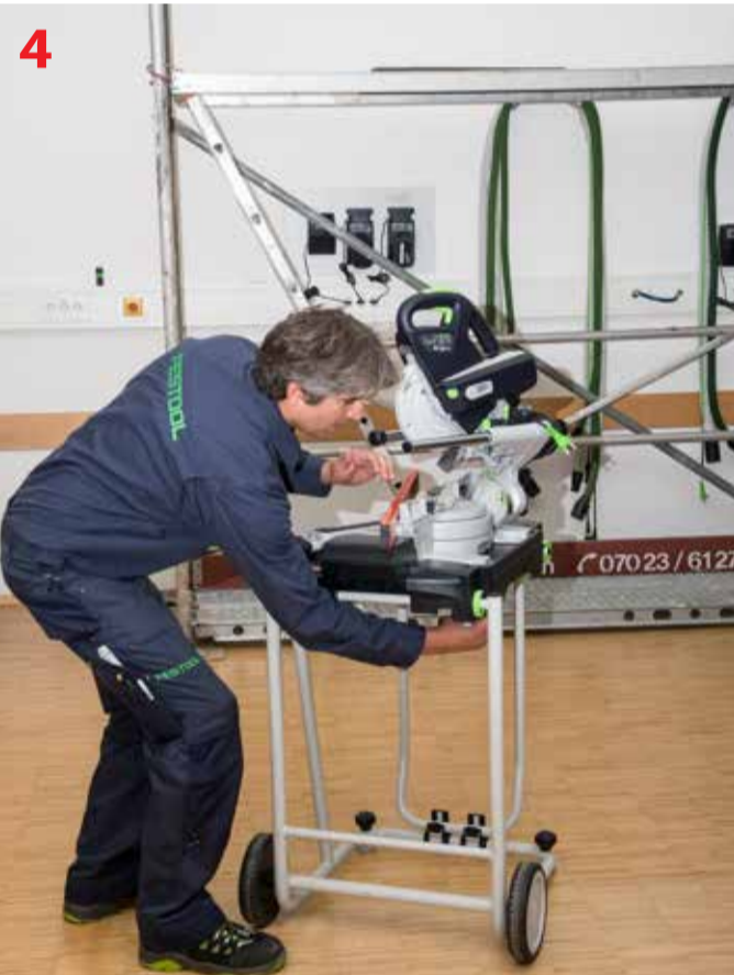
Montaż pilarki Festool Kapex KS 60 na module transportowym
