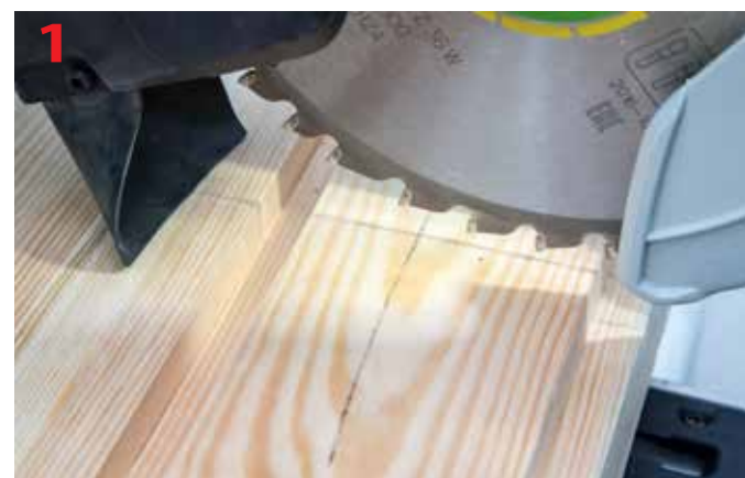
Linia rzazu wyznaczona przez cień tarczy pilarskiej rzutowany światłem ledowym
